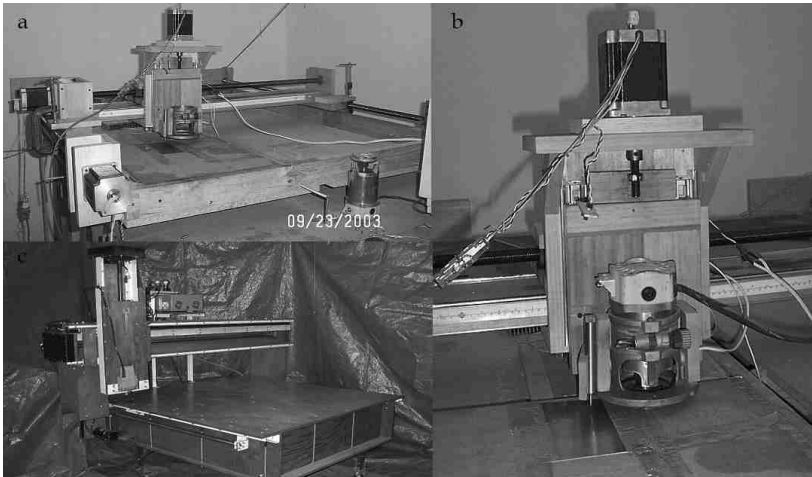
Rys. 4-29. Eksperymentalne drewniane frezarki CNC (SUPER TECH 2008): a, b - konstrukcji Antonio Castry (2003), c - konstrukcji Richarda Koeniga (2004)
