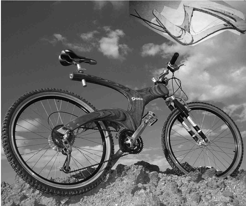
Rys. 4-11. Rower z ramą pozbawioną prostych linii, inspirowaną kształtami natury, produkcji Gotabikes, Brazylia (w górnym prawym rogu – rama o innym kształcie w trakcie produkcji)
