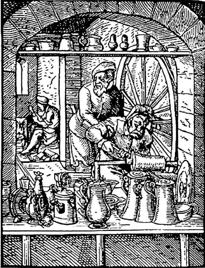
Rys. 3-83. Tokarka o ruchu jednokierunkowym wyposażona w koło zamachowe, Das Ständebuch 1568 (WOODBURY 1963)
