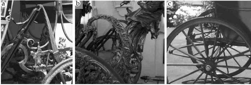
Rys. 3-15. Amortyzacja pojazdów resorami piórowymi: a – system S-kształtnych pionowych drewnianych resorów Dalema (ok. 1770) (fot. P. Pohl), b – system C-kształtnych pionowych drewnianych resorów Polignaca (ok. 1790), c – system poziomych metalowych resorów Elliotta (1804)
