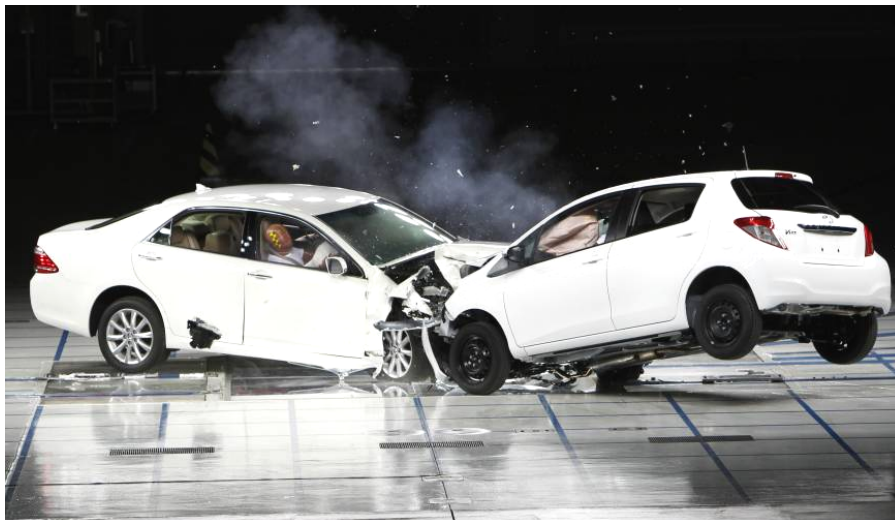
Rys. 3.7. Zjawisko oderwania się kół tylnej osi pojazdu podczas zderzenia
