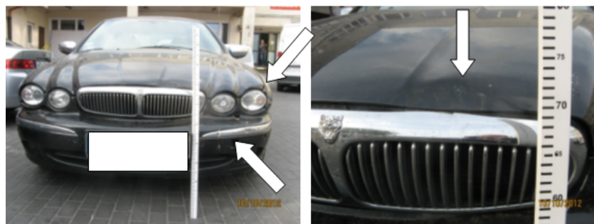
Rys. 3.20. Uszkodzenia w pojazdach w wyniku kolizji wg opinii 2, a) dla pojazdu Dodge, b) dla Jaguara
