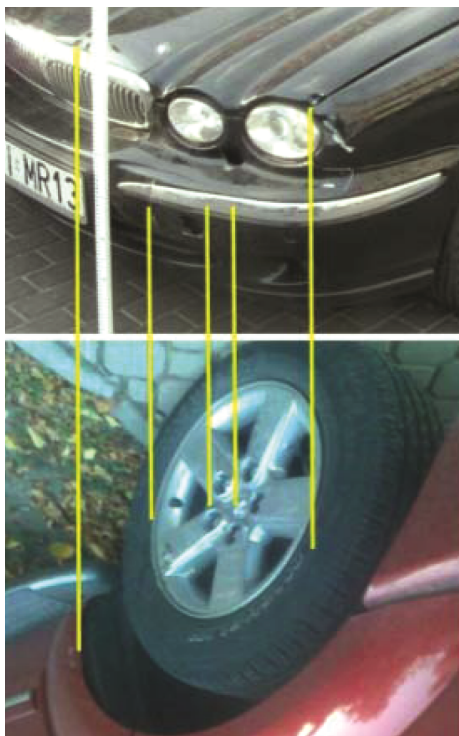
Rys. 3.21. Próba wzajemnego dopasowania uszkodzeń obu pojazdów
