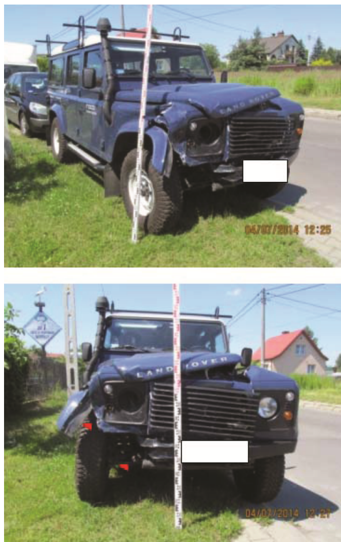
Rys. 3.30. Zakres uszkodzeń dla Land Rovera
