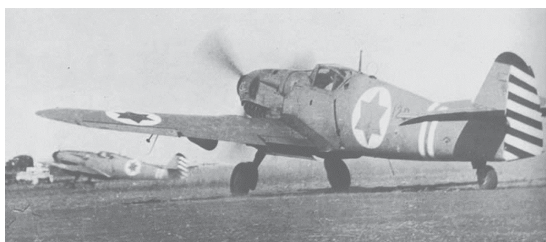
Rys. 1.5. Avia S-199, czyli Messerschmitt BF-109G z silnikiem Junkers Jumo 211F
