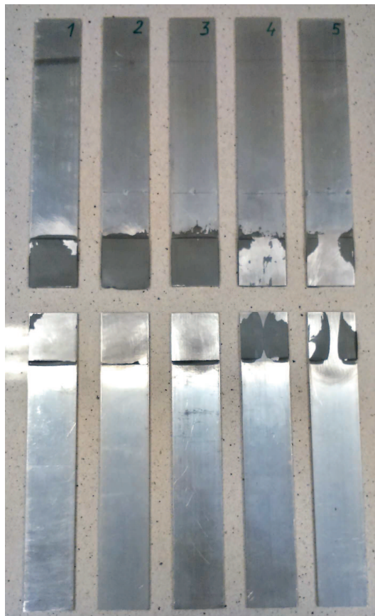
Fot. 3.5. Próbkę 1 – 5 po zniszczeniu
