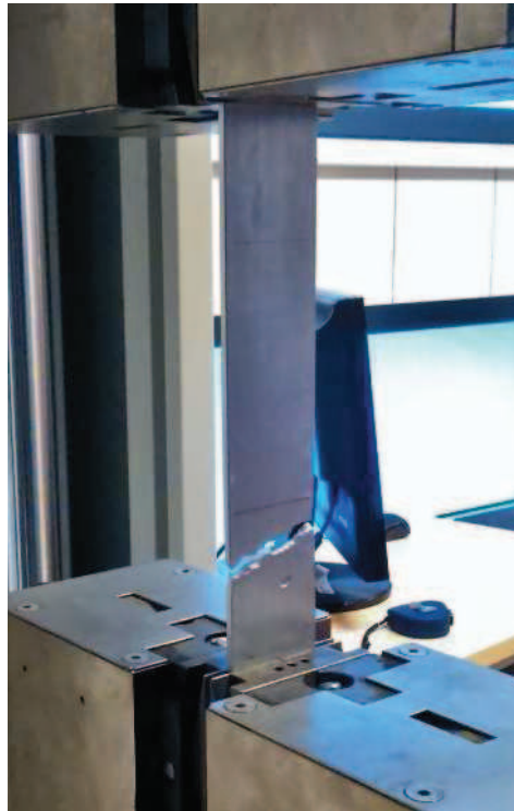
Fot. 3.6. Próbkę 6 po zniszczeniu
