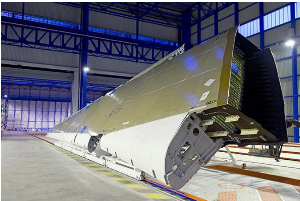
Rys. 10. Skrzydło samolotu Airbus A350 XWB zbudowane z kompozytu węglowego
