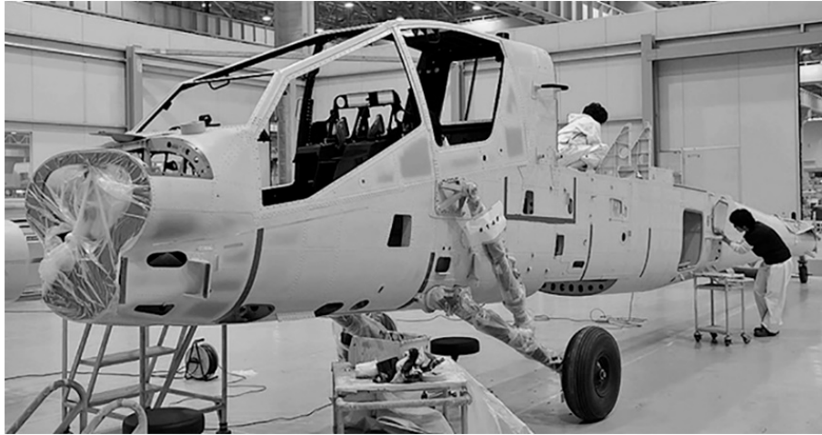
Rys. 13. Jeden z etapów budowy kadłuba śmigłowca Boeing AH-64 wraz z elementami wykonanymi z kompozytu AFRP [19]
