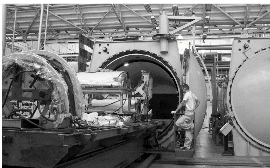
Rys. 8. Etap przygotowania kompozytowej części kadłuba śmigłowca do wstawienia do autoklawu (PZL-Świdnik)
