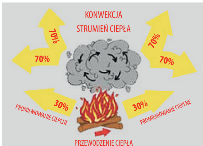
Ryc. 7. Rozkład konwekcji i promieniowania przy przekazywaniu (transporcie) ciepła podczas pożarów
