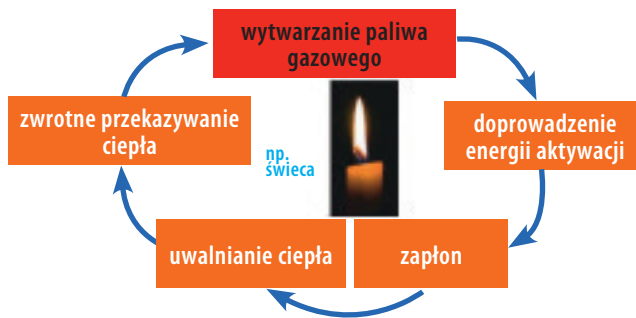
Ryc. 8. Przebieg procesu energetycznego przygotowania materiału do zapalenia
