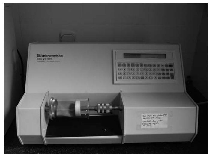
Rys. 3. Piknometr quasi cieczowy Geopyc 1360 (Micromeritics, USA)
