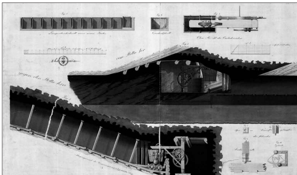
Rys. 9. Przekrój sztolni, portu węglowego, pochylni transportowej (MGW/TG/A: 756)
