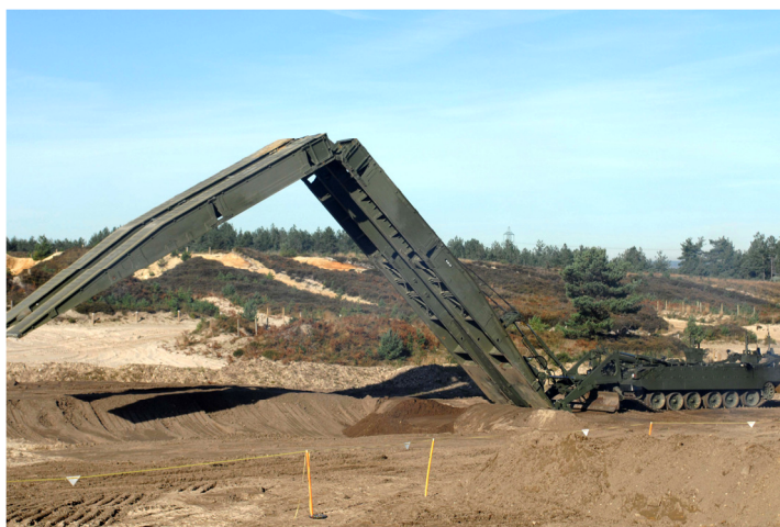
Rys. 6.49 Przykład mobilnego wojskowego mostu tymczasowego konstrukcji nożycowej [źródło: http://www.defenceimagery.mod.uk/ , © Crown copyright 2006, licencja: OGL]
