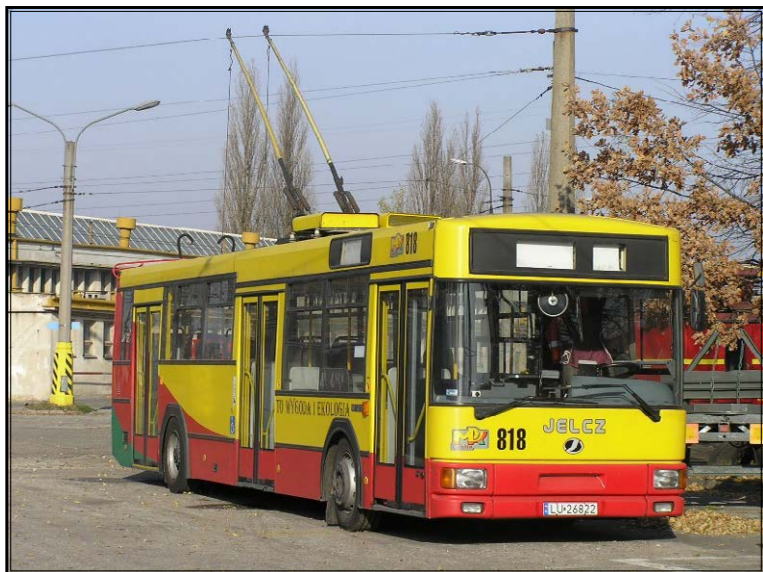
Ryc. 5.15. Częściowo niskopodłogowy trolejbus MPK/Jelcz M121E „Ekobus” zbudowany w warsztatach MPK w Lublinie w 2001 r.
