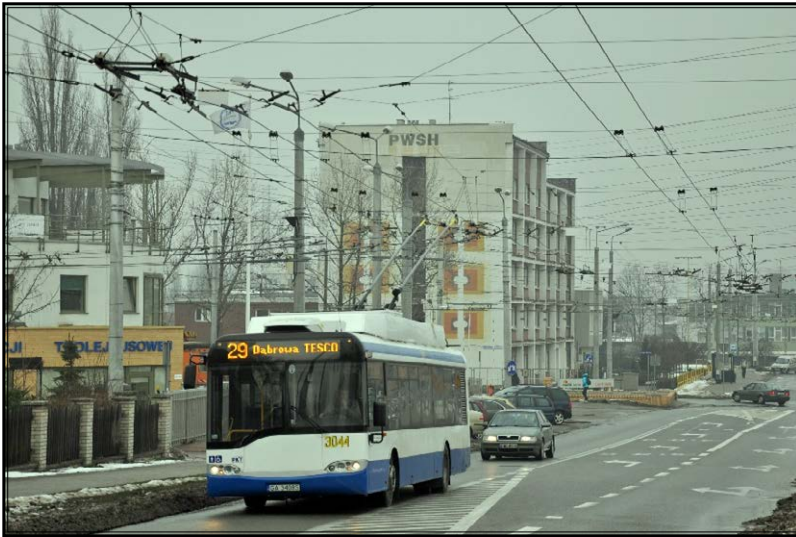
Ryc. 5.14. Trolejbus Solaris Urbnio 12 – ostatni pojazd przebudowany z autobusu niskopodłogowego w Gdyni.
