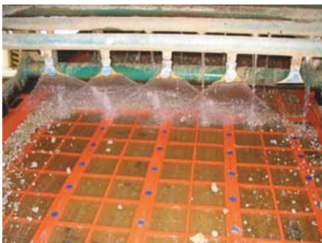
Rys. 4. Poliuretanowy pokład przesiewacza wibracyjnego typu Stack Sizer firmy Derrick (fot. E. Lewicka)
