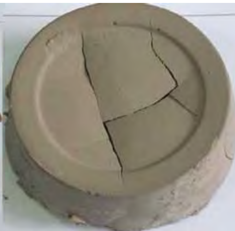
Rys. 8. Próbkę bezilowej płuczki polimerowej zestalone kompozycją środka zawierającego 5 % szkła wodnego sodowego oraz a) 25 % Silmentu, b) 25 % cementu wieloskładnikowego
