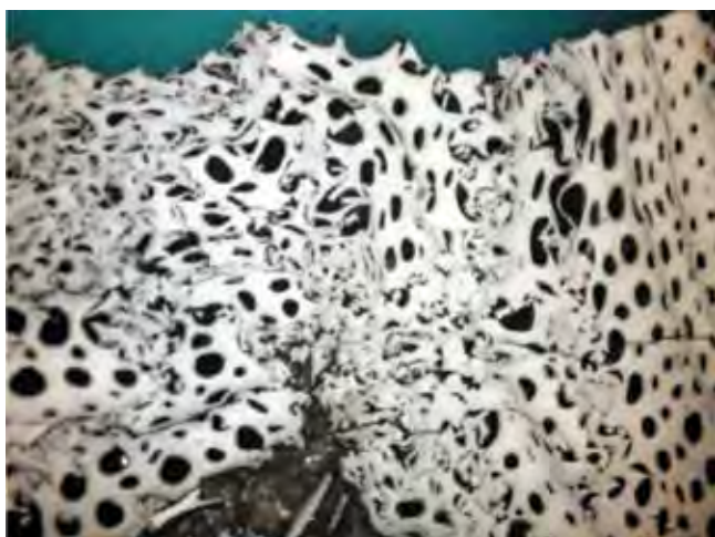
Rys. 3. Grupa inertynyty – fuzynit o pustych, dobrze zachowanych owalnych komórkach. Immersja, pow. 500×
