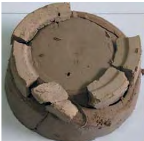
Rys. 8. Próbkę bezilowej płuczki polimerowej zestalone kompozycją środka zawierającego 5 % szkła wodnego sodowego oraz a) 25 % Silmentu, b) 25 % cementu wieloskładnikowego
