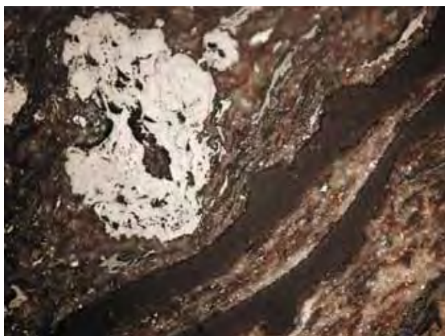
Rys. 14. Karbomineryt zbudowany z mineralów ilastych oraz macerałów grupy inertynitu oraz liptynitu. Kopalnia „Brzeszcze” pokład 352. Immersja, pow. 500×
