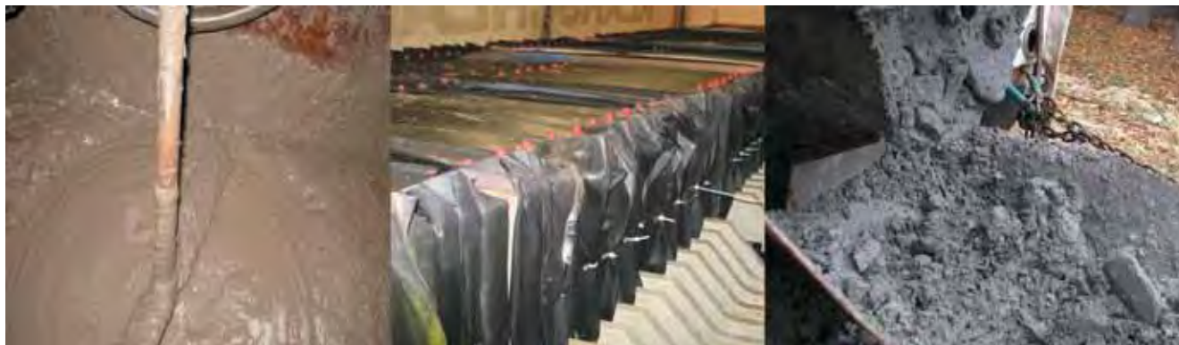
Rys. 1. Skoagulowana płuczka wiertnicza Fig. 1. Coagulated drilling mud
