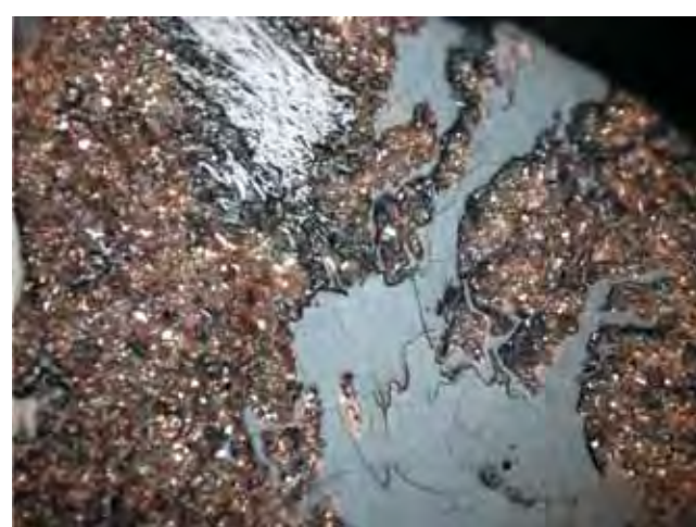
Rys. 4. Fragment karbominerytu – karbargilitu (zrost macerałów z minerałami ilastymi) Immersja, pow. 500×
