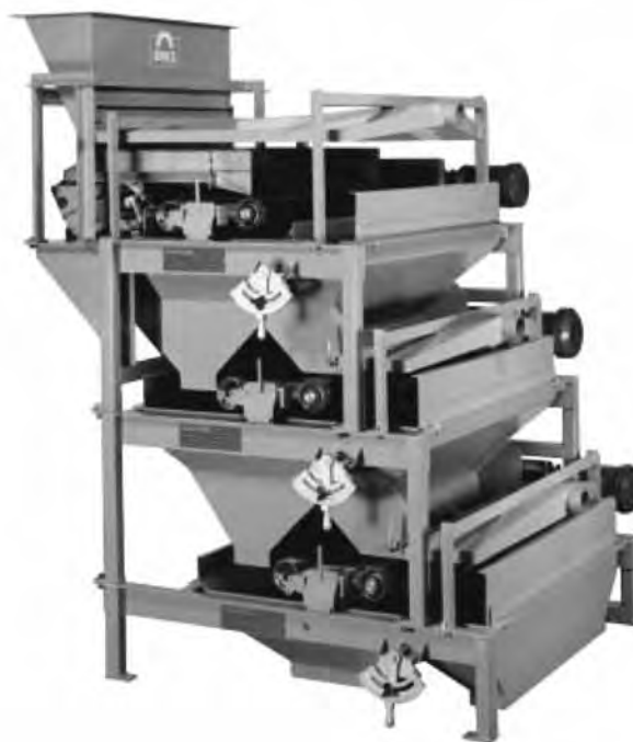
Rys. 3. Trójstopniowy układ separatorów rolkowych RER Fig. 3. Three-stage system of RER roll separators
