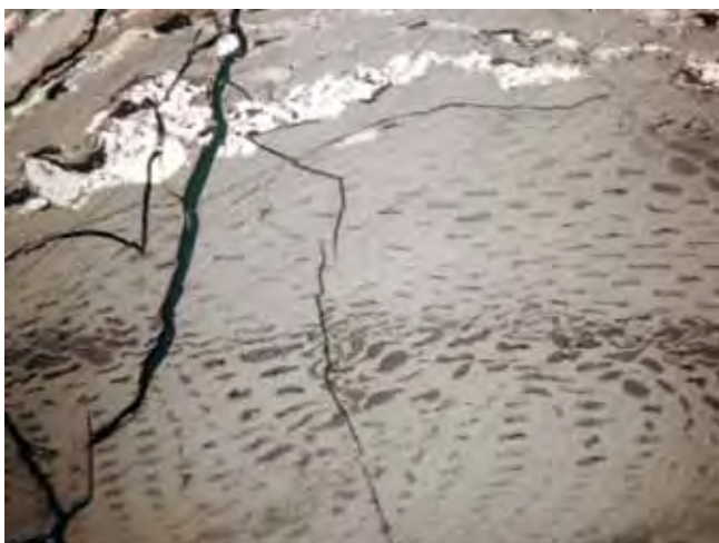
Rys. 1. Grupa wityrynytu: telinit. Jest to komórkowa odmiana macerału z grupy wityrynytu. Na fotografii komórki telinitu wypełnia ciemnoszary rezynit (macerał z grupy liptynytu). Immersja, pow. 500×
