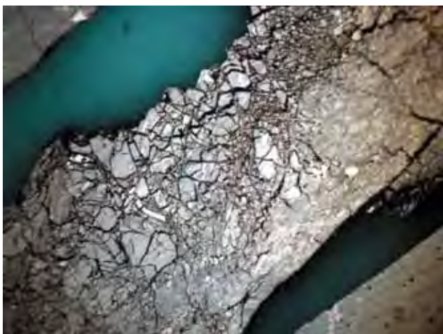
Rys. 8. Okruch kataklastycznego węgla. Kopalnia „Borynia-Zofiówka” pokład 412 lg+ld. Immersja, pow. 500×
