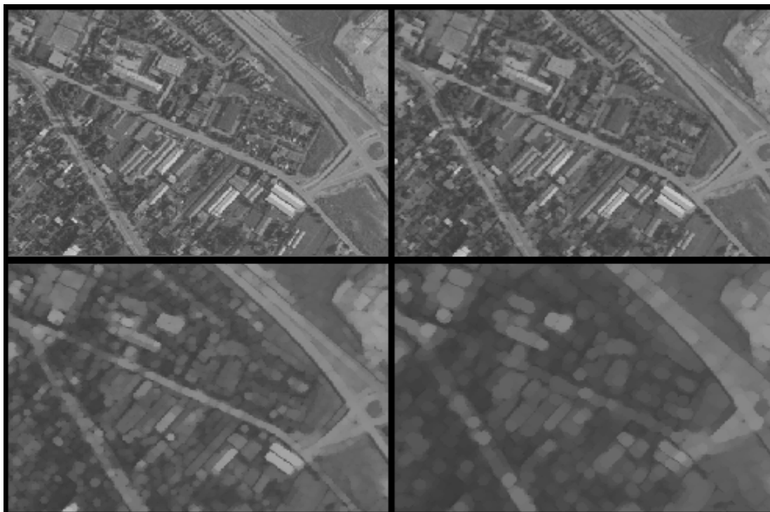
Rysunek 5. Zastosowanie otwarcia; a- obraz oryginalny, obrazy przy użyciu elementu strukturującego w kształcie okręgu o promieniu wielkości 1 piksela (b), 3 pikseli (c), 8 pikseli (d) (źródło: opracowanie własne)
