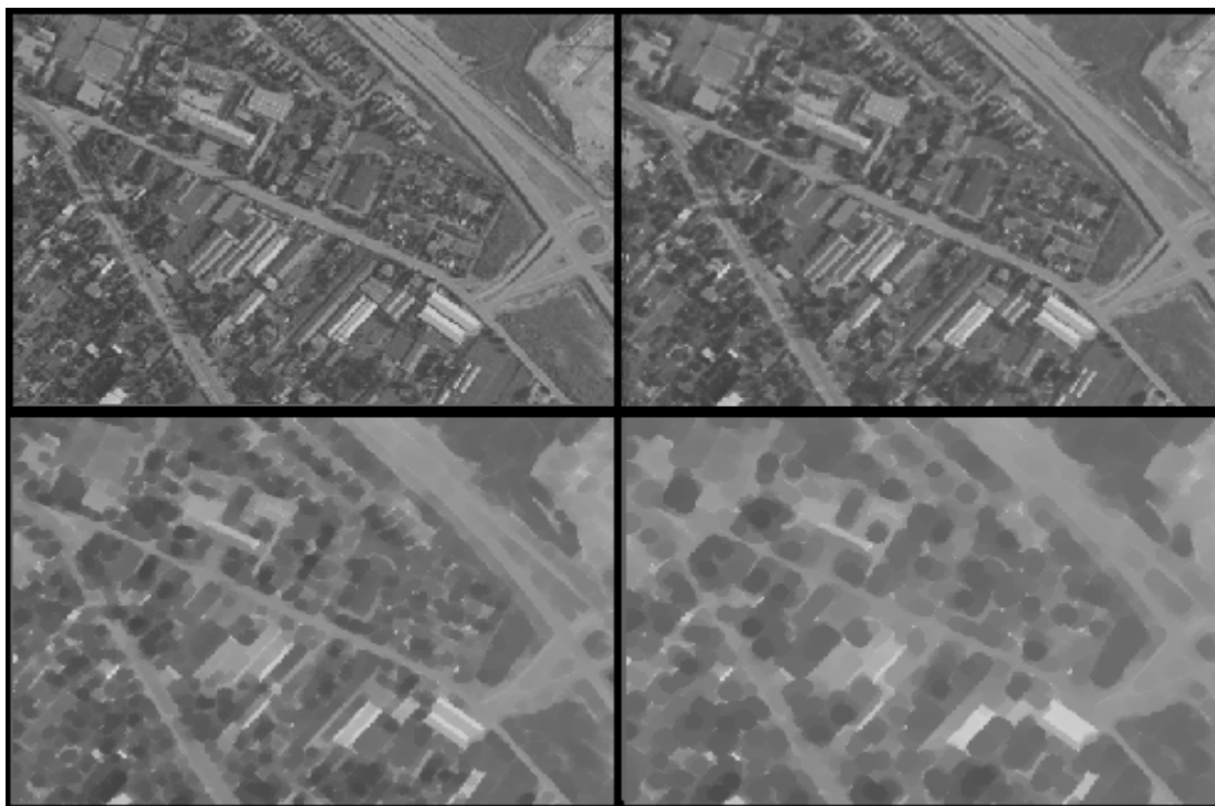
Rysunek 6. Zastosowanie domknięcia; a- obraz oryginalny, obrazy przy użyciu elementu strukturującego w kształcie okręgu o promieniu wielkości 1 piksela (b), 3 pikseli (c), 8 pikseli (d) (źródło: opracowanie własne)
