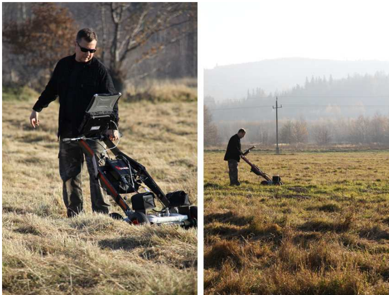
Rys. 12. Profilowanie georadarowe niedostępnego odcinka sztolni za zawalem (w tle zalesione wzniesienie gdzie znajdowała się kopalnia „Hundsruicken” – zwraca uwagę bardzo niewielkie nachylenie terenu, pod którym biegnie w jego kierunku wyrobisko sztolni)
