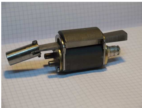
Fot. 1. Przetwornik TPZN-1 z płytką dociskową 11,4 cm 2
