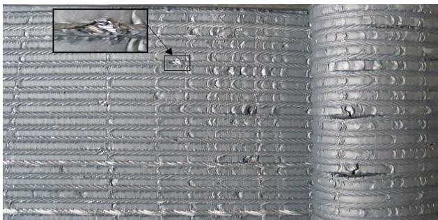
Rys. 2. Widok uszkodzeń po odwarstwieniu okładki nośnej taśmy ST 2000
