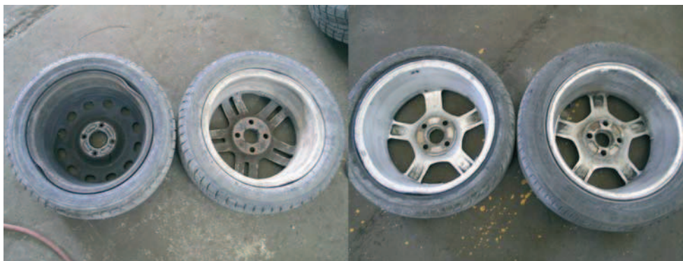
Rys. 12. Porównanie uszkodzeń felgi stalowej i aluminiowej przy tym samym typie opony.
