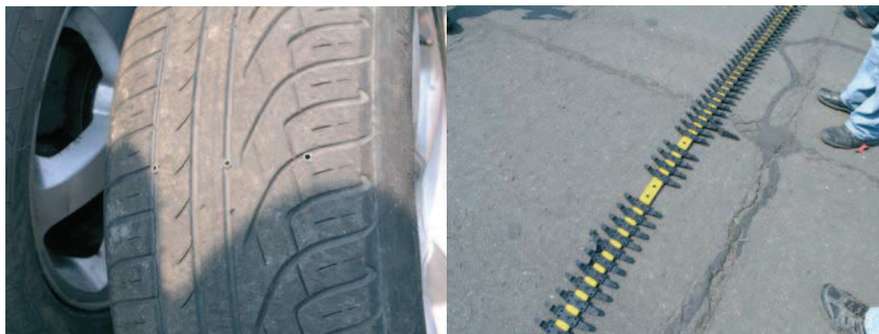
Rys. 1. i 2 Widok kolców wbitych w oponę oraz kolczatki po próbie przejazd.
