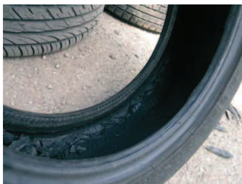
Rys. 6. Widok zużycia wewnętrznej strony opony typu RSC.
