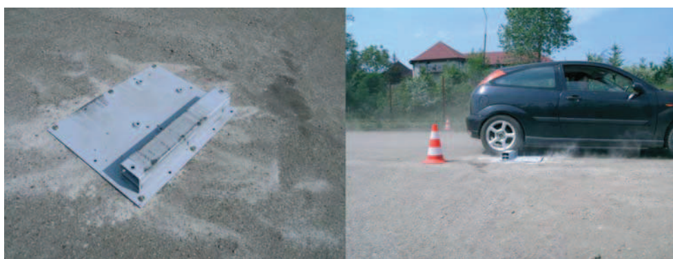
Rys. 11. Widok przeszkody do sprawdzania odporności felg i opon na obciążenia udarowe oraz pojazdu podczas próby.
