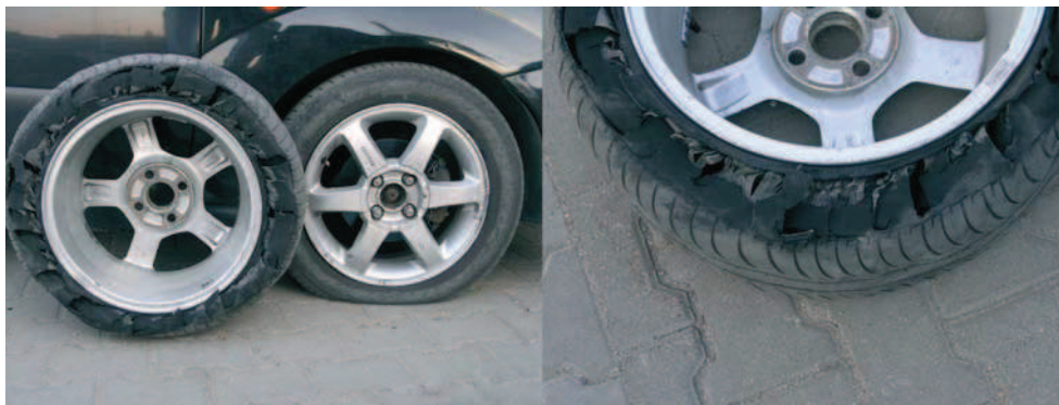
Rys. 5. Porównanie widocznego zużycia zewnętrznego opony standardowej (z lewej) z oponą typu RSC.
