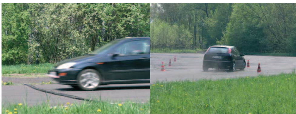
Rys. 3 i 4. Widok pojazdu przejeżdżającego przez kolczatkę i próba wejścia w łuk pojazdu z przebitymi oponami osi przedniej (pojazd silnie podsterowny).
