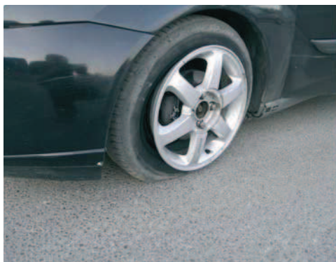
Rys. 7. Widok opony typu RSC – stopka opony uległa znaczącemu przesunięciu się na feldze.
