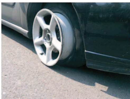
Rys. 9. i 10. Widok uszkodzeń standardowych opon po jeździe bez powietrza.
