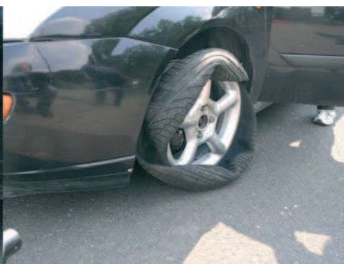
Rys. 9. i 10. Widok uszkodzeń standardowych opon po jeździe bez powietrza.
