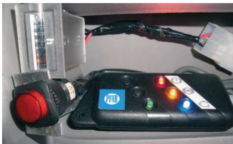
Rys. 5. Widok panelu z lampkami kontrolnymi LED, obok czerwony przycisk hamulca bezpieczeństwa, powyżej przycisku - licznik czasu pracy sprężarek w naczepie/przyczepie.
