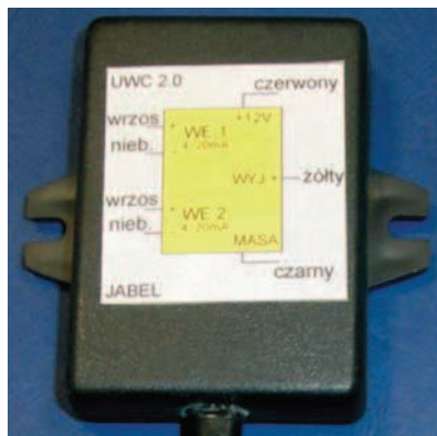
Rys. 4. Widok komparatora sygnałów prądowych z przetworników ciśnienia płynu hamulcowego obwodów pompy hamulcowej pojazdu holującego.
