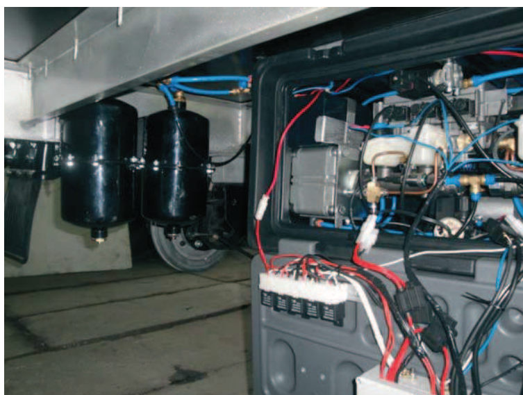
Rys. 8. Układ PEBS zamontowany w naczepie PIMR N1, lewej strony widoczny zbiornik główny (2 x 4,6 dcm 3 ).
