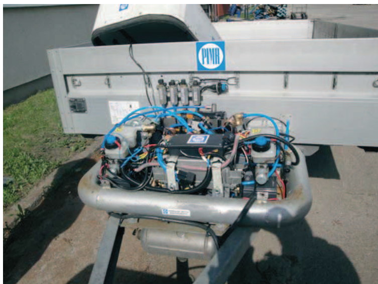
Rys. 7. Układ PEBS na przyczepie PIMR P1 (stan z marca 2010) z akumulatorami żelowymi wewnątrz przestrzeni utworzonej z rury zbiornika głównego.
