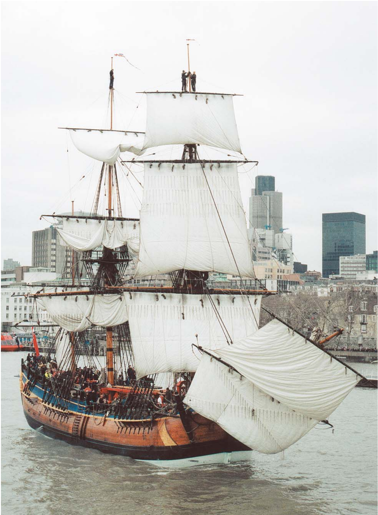
Fig. 4. The Endeavour replica in the Thames 1997. Note the square bows, and the box-like appearance (photo by S. Baines). Il. 4. Replika Endeavoura na Tamizie w 1997 roku. Zwraca uwagę tępy dziób i pełnotliwość kadłuba (fot. S. Baines).
