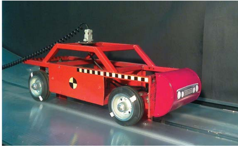
Rys. 10. Przykładowa realizacja strefy zgniotu w ramach projektu studenckiego
