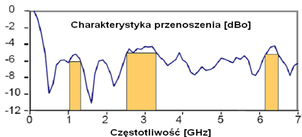
Rys. 1. Charakterystyka przenoszenia światłowodu MM 62,5 \mu\text{m} , o długości 500m, VCSEL, 850 nm, [14]
