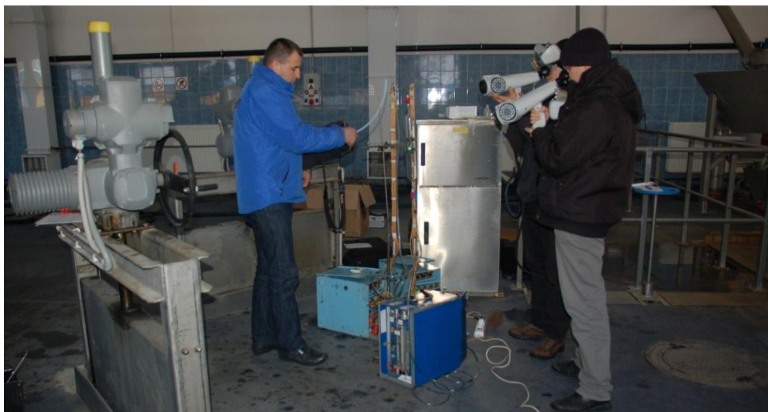
Rys. 4-9 Pobieranie próbek powietrza do oznaczeń olfaktometrycznych niebezpośrednich, oznaczeń siarkowodoru i amoniaku metodą kolorymetryczną, oznaczeń tioli i siarczków metodą chromatograficzną oraz pomiar D/T przy użyciu OT w budynku sit w Oczyszczalni Ścieków „Piaseczno” (fot. wł.)
