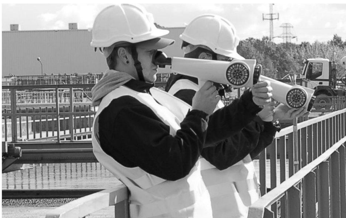
Rys. 4-5 Pomiar wartości D/T przy użyciu OT Nasal Ranger® (fot. wł.)
