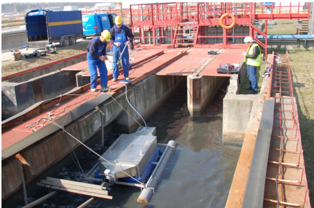
Rys. 4-8 Pobieranie próbek powietrza do oznaczeń olfaktometrycznych niebezpośrednich z piaskownika (źródło pasywne) za pomocą obudowy z wymuszonym przepływem powietrza (fot. wł.)
