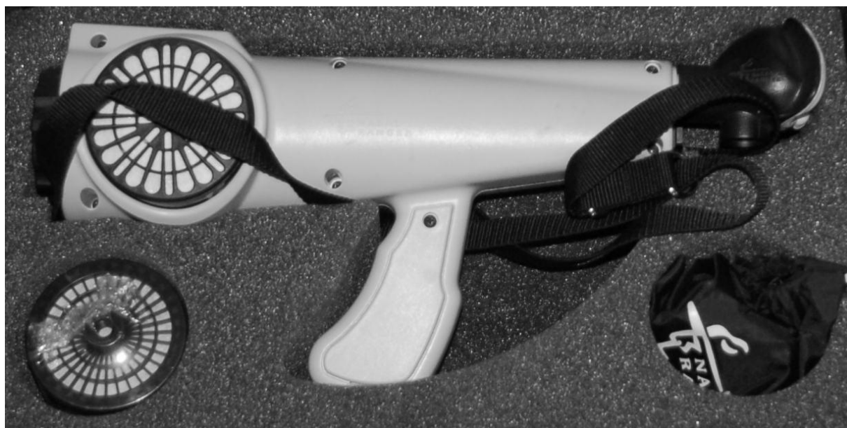
Rys. 4-1 Olfaktometr terenowy Nasal Ranger® (fot. wł.) Fig. 4-1 Field olfactometer Nasal Ranger® (own fot.)
