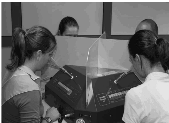
Rys. 2-1 Pomiary olfaktometryczne olfaktometrem T08 wyprodukowanym przez firmę Ecoma (Hohenstein Institute) Fig. 2-1 Olfactometric measurement T08 olfactometer manufactured by Ecoma (Hohenstein Institute)
