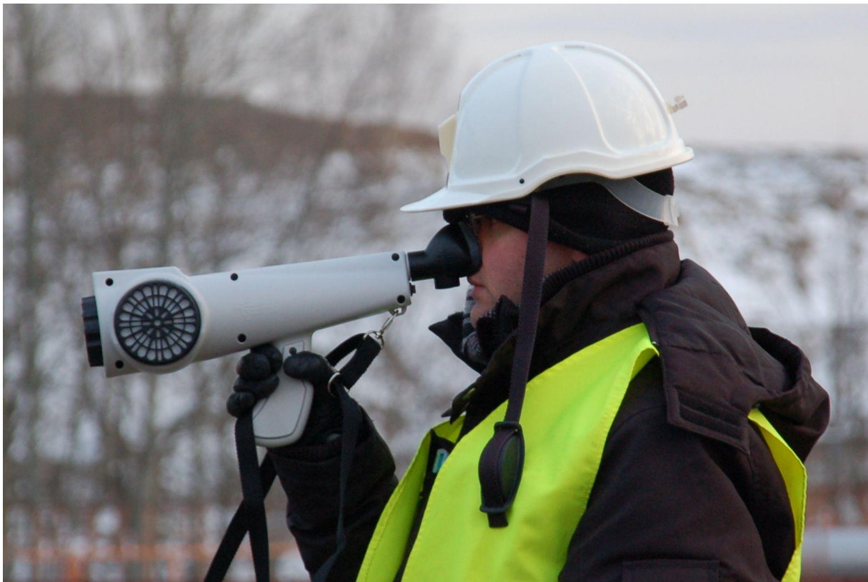
Rys. 2-3 Pomiary olfaktometryczne olfaktometrem terenowym Nasal Ranger® (fot. wł.) Fig. 2-3 Olfactometry measurement of Nasal Ranger® Field Olfactometer (own fot.)
