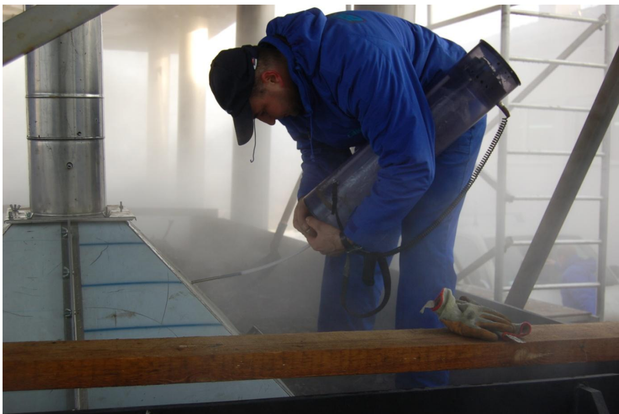
Rys. 4-6 Pobieranie próbek powietrza z biofiltra, z wykorzystaniem osłony strumienia, do oznaczeń olfaktometrycznych niebezpośrednich (fot. wł.)
