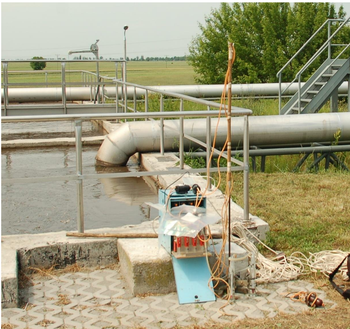
Rys. 4-12 Pobieranie próbek powietrza do tedlarowych worków do oznaczeń chromatograficznych oraz próbek do oznaczeń siarkowodoru i amoniaku metodą kolorymetryczną – otoczenie reaktorów biologicznych w Oczyszczalni Ścieków w Rybieniu Starym (fot. wł.)
