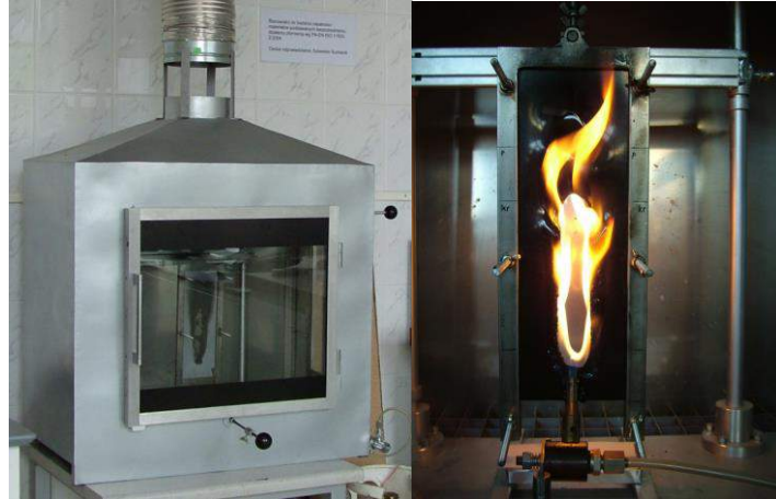
Ryc. 31 Stanowisko badawcze wg. PN-EN ISO 11925-2, stosowane w Zespole Laboratoriów Procesów Spalania i Wybuchowości CNBOP-PIB
