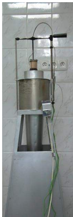
Ryc. 28. Stanowisko do badania niepalności, stosowane w Zespole Laboratoriów Procesów Spalania i Wybuchowości CNBOP-PIB
