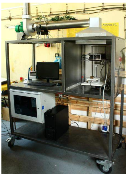
Ryc. 27. Kalorymetr stożkowy do pomiaru szybkości wydzielania ciepła podczas pożarów, stosowany w Zespole Laboratoriów Procesów Spalania i Wybuchowości CNBOP-PIB
