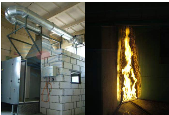
Ryc. 30. Stanowisko badawcze wg PN-EN 13823, stosowane w Zespole Laboratoriów Procesów Spalania i Wybuchowości CNBOP-PIB
