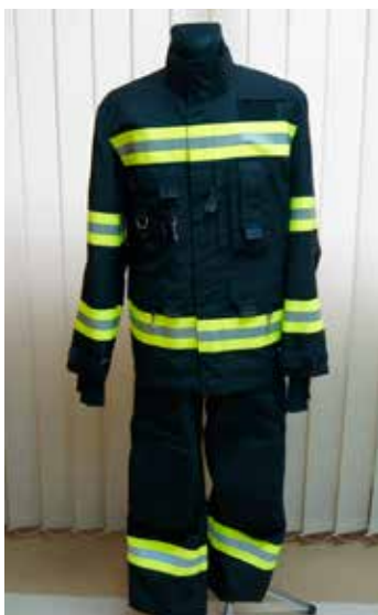
Ryc. 1. Widok ubrania do działań ratowniczo-gaśniczych na przestrzeniach otwartych Źródło: Archiwum CNBOP-PIB.
