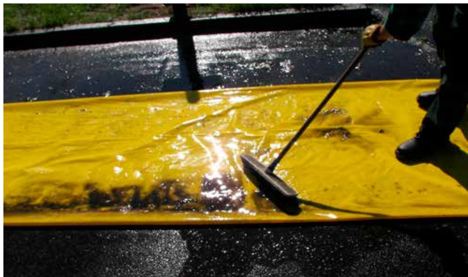
Ryc. 8. Czyszczenie rękawa przeciwpowodziowego
