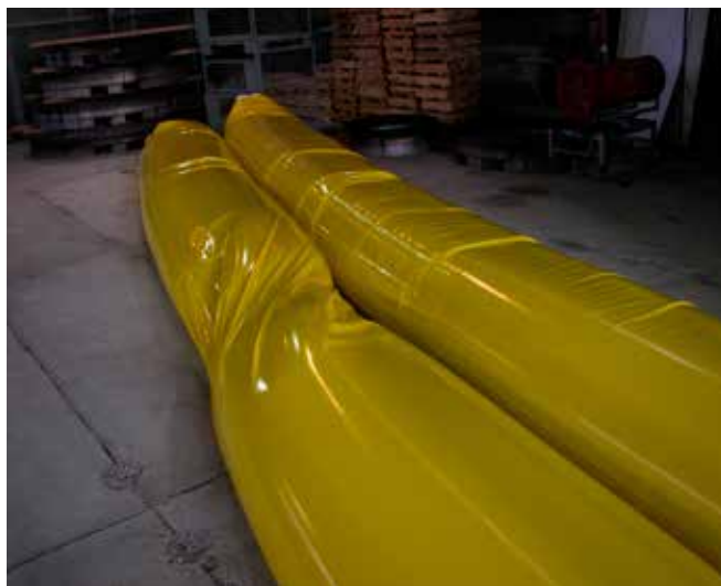
Ryc. 5. Nieprawidłowo sprawiony rękaw przeciwpowodziowy ze skrzyżowanym rękawem wewnętrznym
