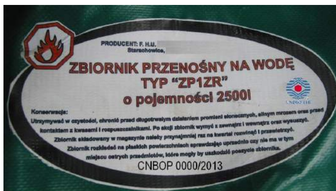
Ryc. 86. Przykładowe cechowanie zbiornika 199
