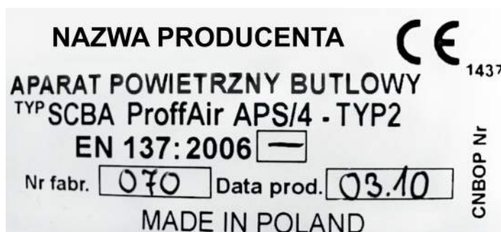
Ryc. 48. Przykładowa tabliczka znamionowa aparatu 126
