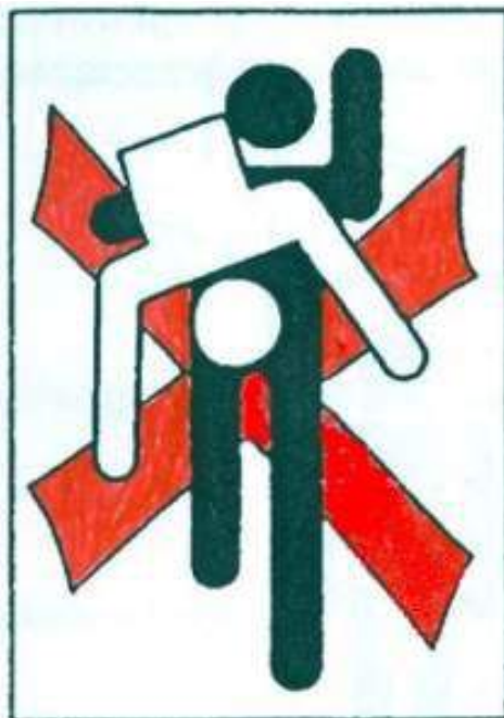
Ryc. 95. Znakowanie drabiny zabraniającej osób znoszenia i wnoszenia 218
