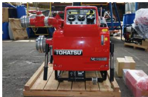
Ryc. 112. Motopompa przenośna M 8/8 260
