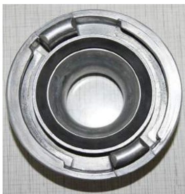
Ryc. 28. Przełącznik wielkości 75/52 od strony 75 70
