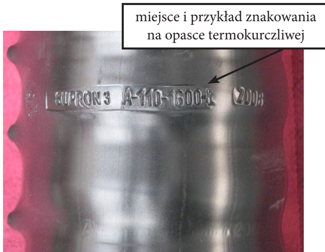
Ryc. 43. Przykładowe znakowanie węża ssawnego typu A (z gumy) 109
