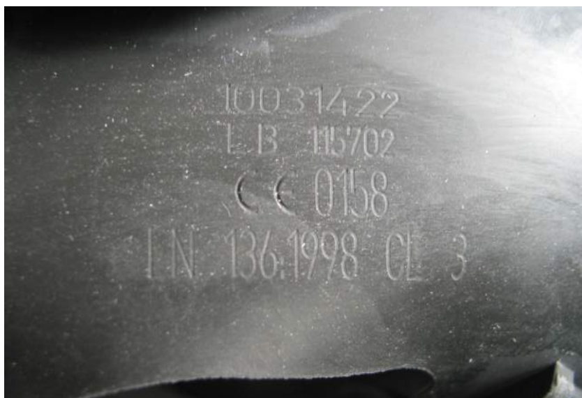
Ryc. 50. Przykładowe cechowanie maski do aparatu powietrznego 130
