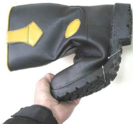
Ryc. 106. Test poprawności połączenia podeszwy z przyszwą 245
