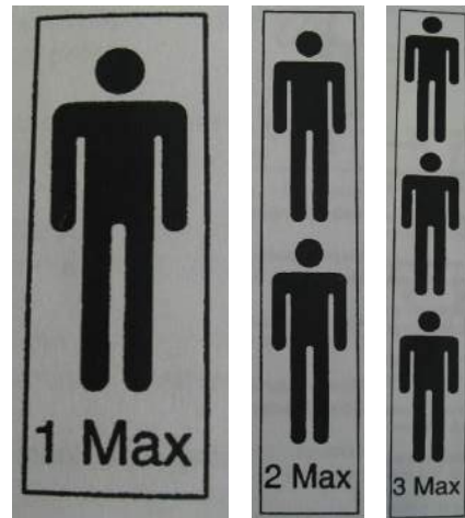
Ryc. 96. Oznaczenie dopuszczalnej liczby mogących przebywać jednocześnie na drabinie 219
