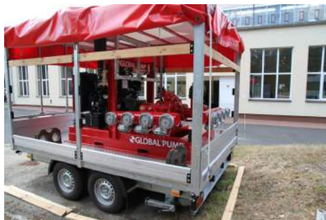
Ryc. 117. Motopompa przewoźna P-64/2 262
