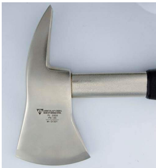
Ryc. 84. Przykładowe znakowanie toporka 195
