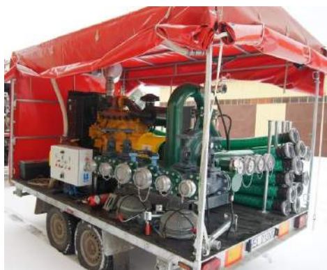
Ryc. 113. Motopompa przewoźna M80/8 260
