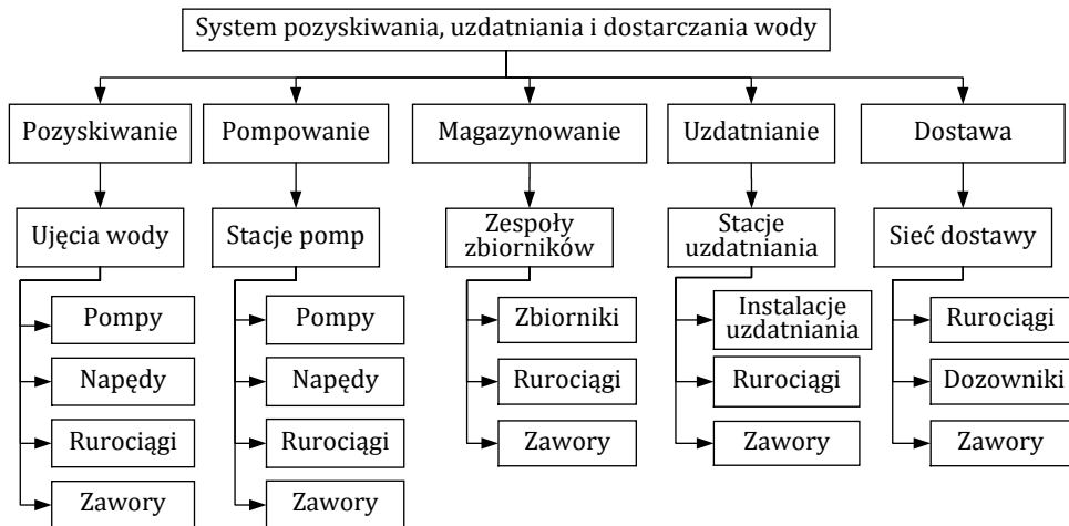
Rys. 1. Etapy pozyskiwania, uzdatniania i dostarczenia wody [1]
