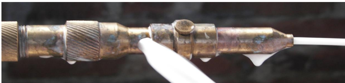
Ryc. 13 Widok fragmentu prądownicy podczas przepływu piany
