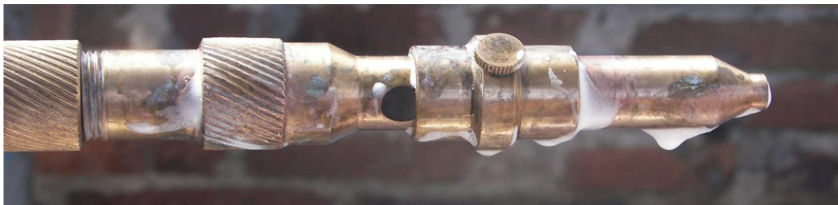
Ryc. 12 Fragment prądownicy z przysłoniętym otworem odprowadzającym nadmiar piany
