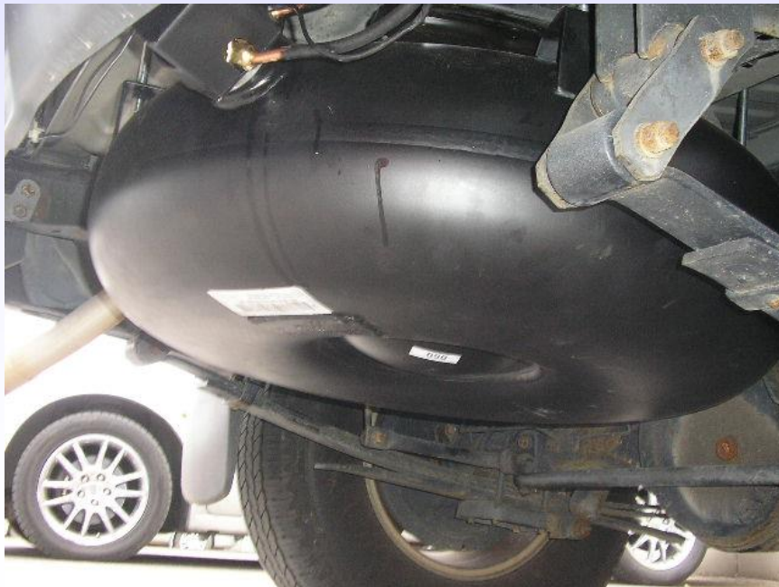
zbiornik o przekroju toroidalnym pod pojazdem
