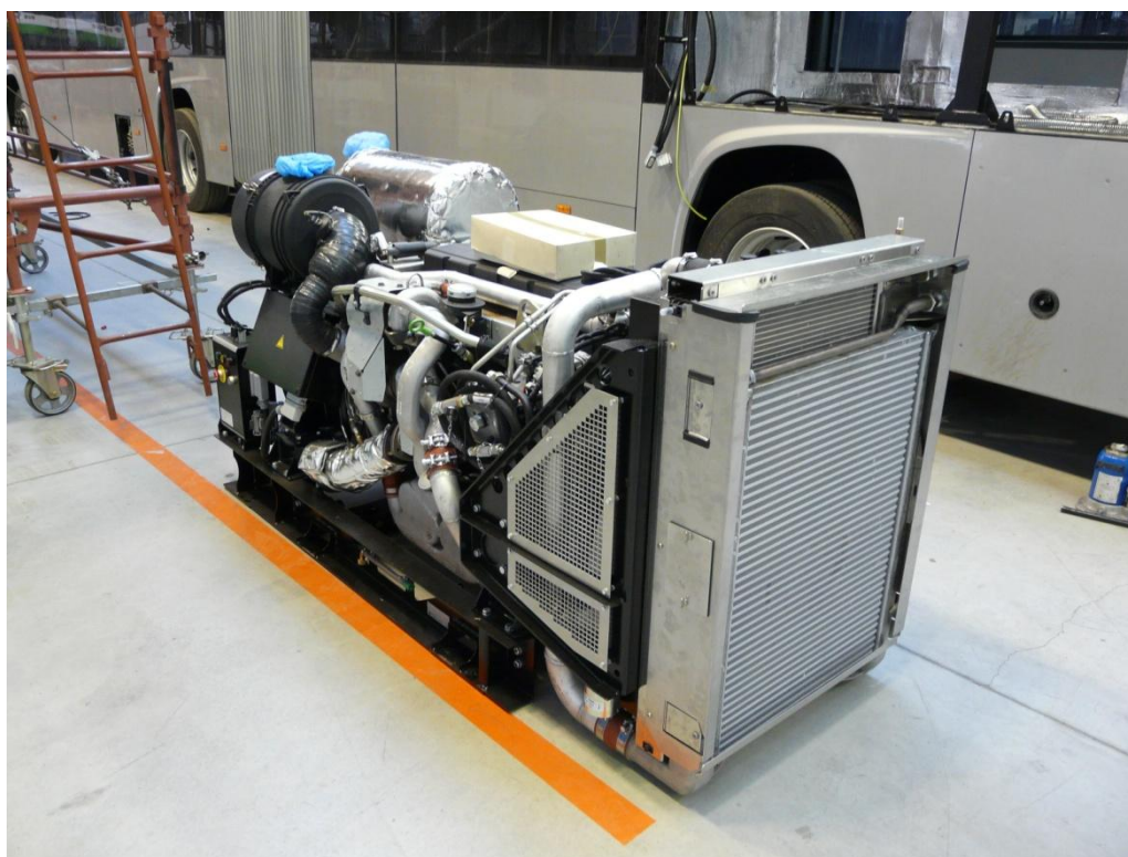
Rys. 2. Agregat spalinowy przygotowany do zamontowania w przegubowym trolejbusie Breda MenariniBus dla Rzymu, zabudowywanym napędem elektrycznym przez firmę Škoda Electric [1, 7].
