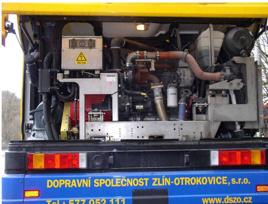
Rys. 1. Agregat spalinowy diesla zamontowany w trolejbusie Škoda 24Tr w przedsiębiorstwie trolejbusowym Zlín-Otrokovice.
