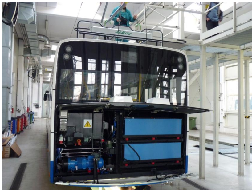
Rys. 3. Dwa moduły baterii nikielowo-kadmowych zabudowanych w trolejbusie Solaris Trollino 12M w Gdyni [8].
