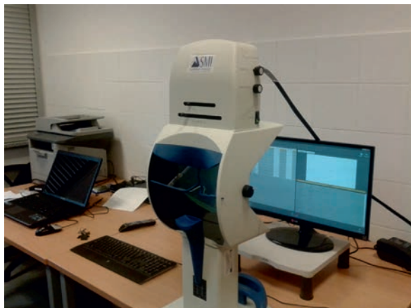
Ryc. 4.9. Stanowisko badawcze wyposażone w okulograf SMI iView X™ Hi-Speed 1250
