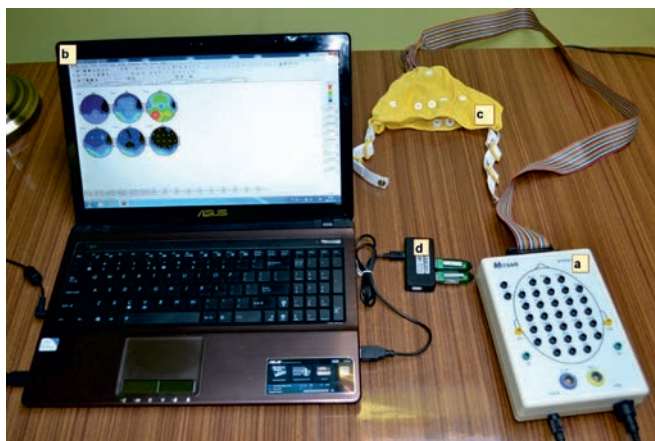
Ryc. 3.18. Zestaw do rejestracji sygnału EEG wraz z oprogramowaniem do analizy QEEG
