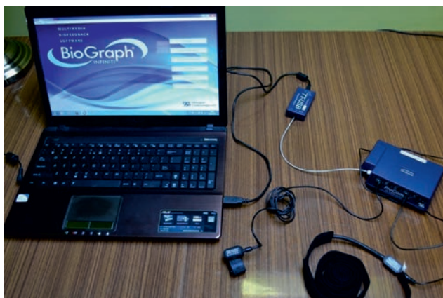
Ryc. 3.23. Stanowisko badawcze wykorzystujące czujnik BVP do pomiaru zmienności rytmu serca (fotopletyzmoigrafii) oraz czujnik oddychania do pomiaru amplitudy i rytmu oddychania
