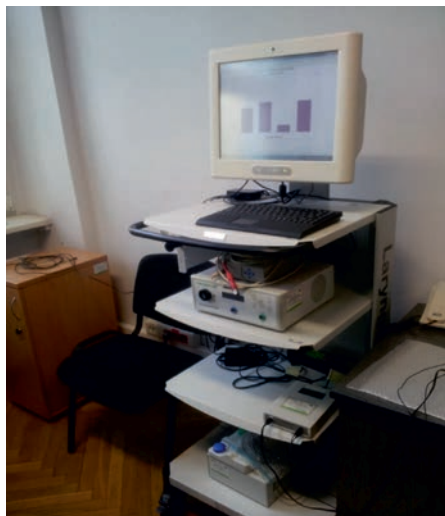
Ryc. 2.16. Mobilne stanowisko badawcze głosu i mowy oparte na działaniu urządzenia o nazwie Laryngograph microProcessor, model EGG-D400. Zakup współfinansowany z European Regional Development Fund under the Infrastructure and Environment Program UDA-POIS.13.01-023/09-00
