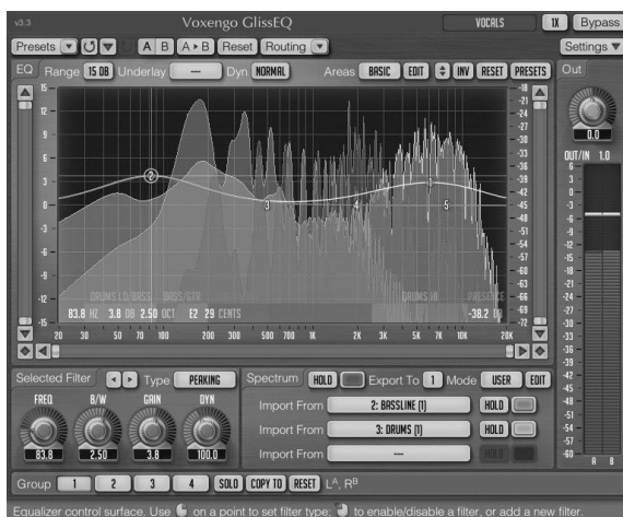
Ryc. 5 Korektor dynamiczny (wielopasmowy) z możliwością analizy widmowej w czasie rzeczywistym, mający zastosowanie w masteringu, program komputerowy firmy Voxengo Źródło: Zrzut ekranowy
