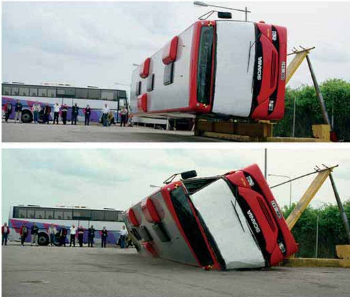
Fig. 4. Actual bus rollover test (photo: Scania) [4]
