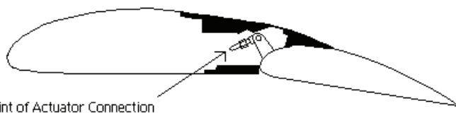
Rys. 2.21 Konwencjonalny układ skrzydła i kłapy [15]
