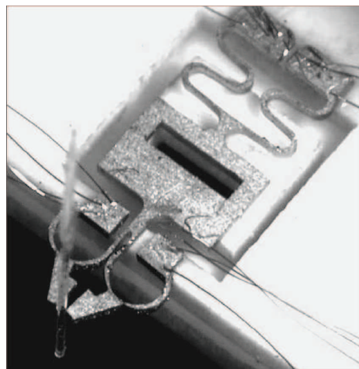
Rys. 2.12. Chwytnak zaciskający włókno światłowodowe średnicy 140 \mu\text{m} M. Kohl, B.Krevet, E. Just [11]
