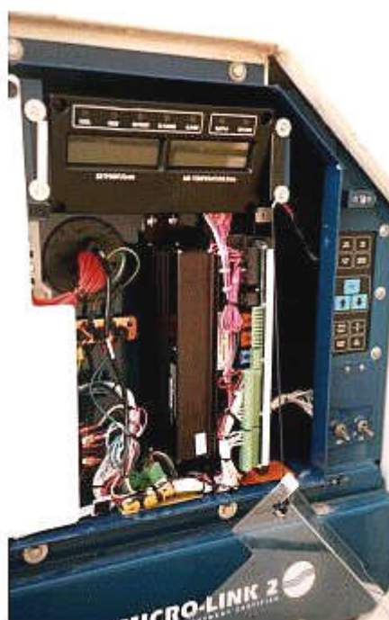
Rysunek 4. Moduł kontrolujący warunki panujące w kontenerze izotermicznym Źródło: http://www.containerhandbuch.de
