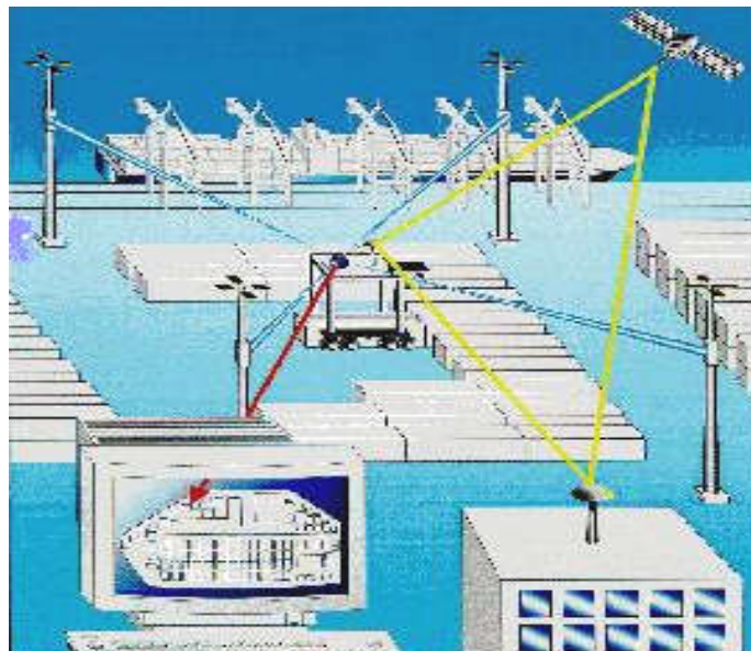
Rysunek 3. Sposób określania pozycji wozu bramowego Źródło: http://www.hhla.de
