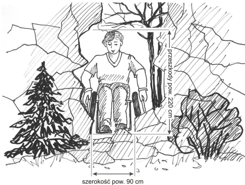
Rys. 13. Przeszkody wystające i zwisające nad trasą
