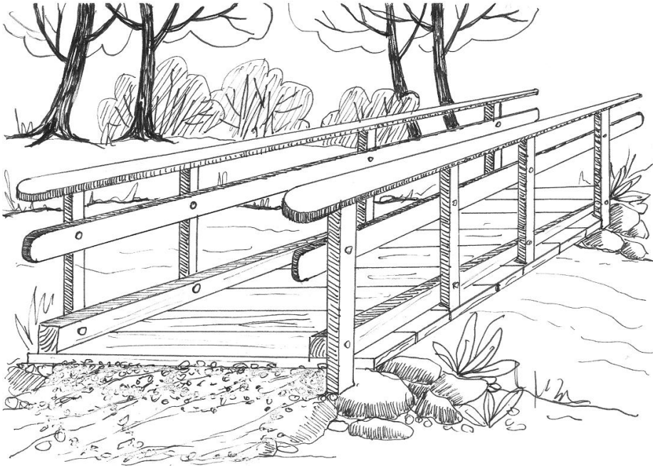
Rys. 24. Poręcze na terenie o płaskiej nawierzchni
