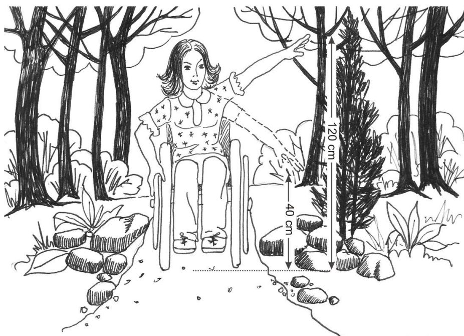
Rys. 28. Zasięg ramion osób niepełnosprawnych ustawionych bokiem do sięganego przedmiotu
