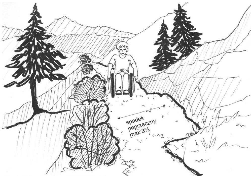
Rys. 8. Poprawne nachylenia poprzeczne trasy
