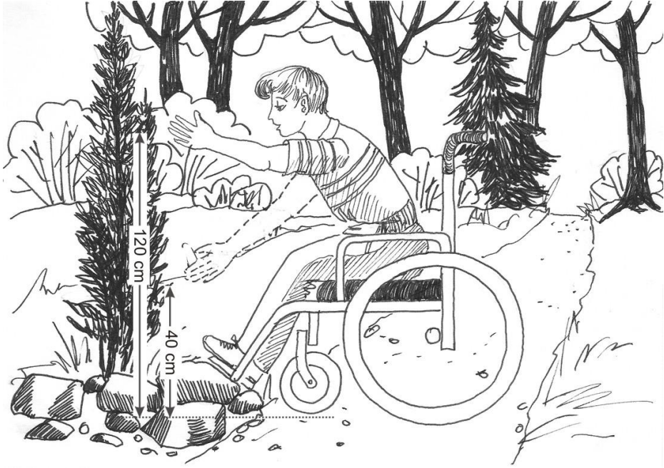
Rys. 29. Zasięg ramion osób niepełnosprawnych ustawionych przodem do sięganego przedmiotu
