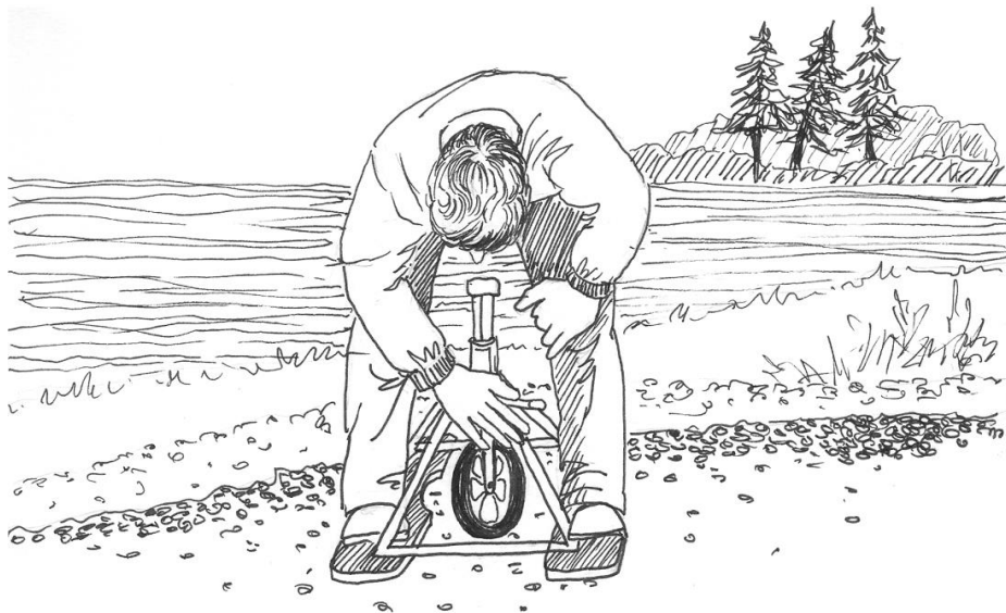
Rys. 10. Zwięzłościomierz (pentrometr) obrotowy
