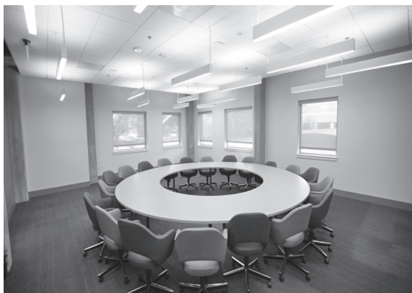
Il. 13. Przykład sali lekcyjnej zaprojektowanej w nurcie universal learning design dla studentów z wadą słuchu. Warto zwrócić uwagę na położenie okien i wielopunktowe oświetlenie
