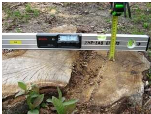
Rysunek 4: Pomiar wysokości progu bezpieczeństwa.
