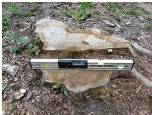
Rysunek 5: Pomiar kąta pochylenia płaszczyzny rządu podcinającego poprzecznie do kierunku obalania drzewa.
