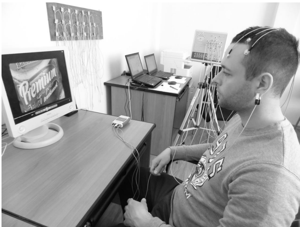
Rysunek 1. Rejestracja sygnałów EEG, GSR i EKG podczas oglądania przez badanego filmu przerywanego blokami reklamowymi
