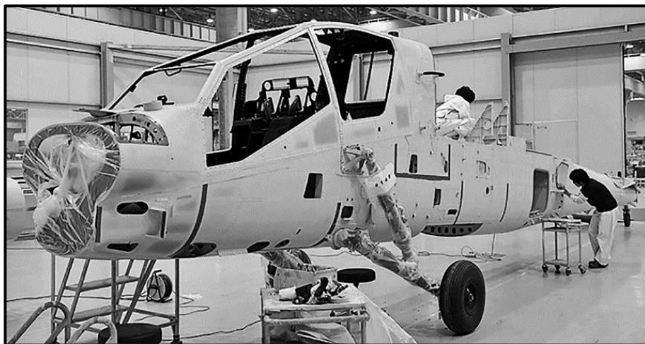
Fot. 6. Jeden z etapów budowy kadłuba śmigłowca Boeing AH-64 wraz z elementami wykonanymi z kompozytu AFRP
