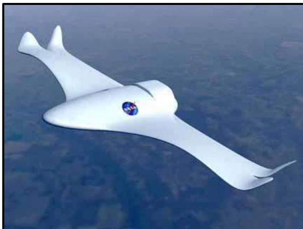
Fot. 1. Morphing Airplane – statek powietrzny zmieniający kształt w zależności od danych potrzeb podczas lotu
