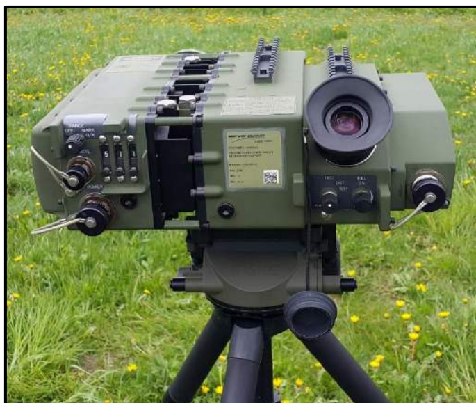
Fot. 15. Naziemny system podświetlania celów GLTD II
