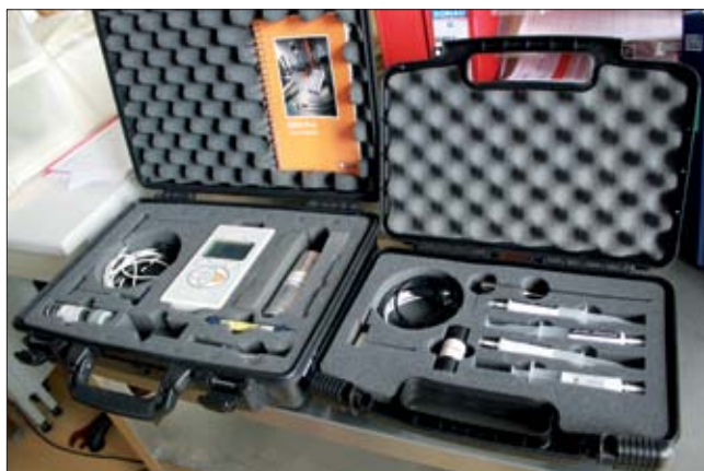
Rys. 40. Igła termiczna z zestawem wymiennych końcówek pomiarowych dostosowanych do różnych materiałów (skały, grunty, mieszanki do iniekcji otworów itd.). Fot. A. Łukawska
