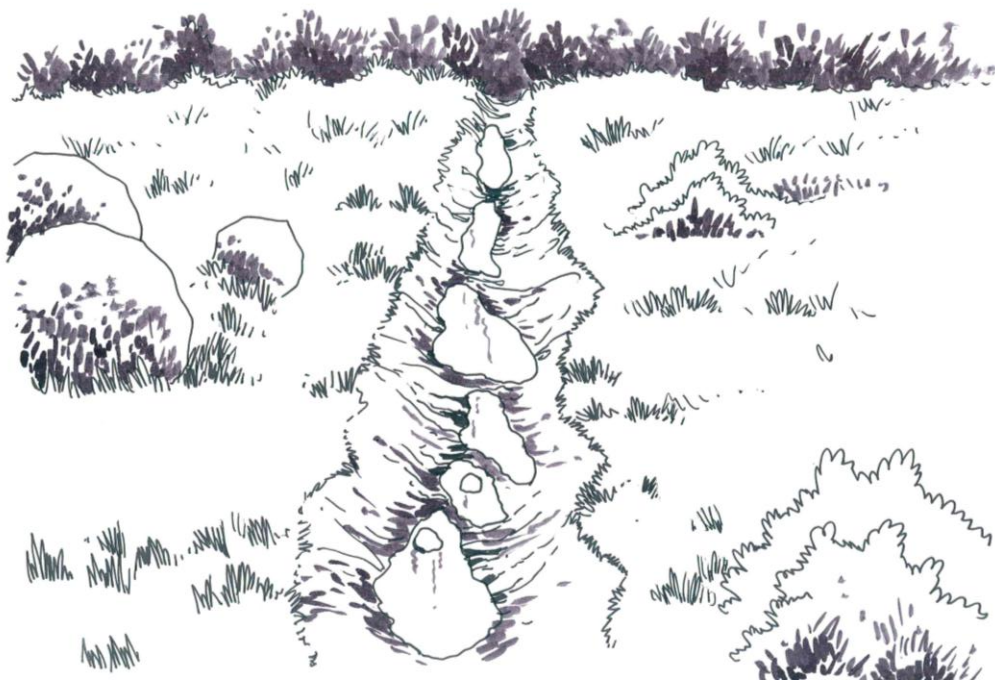
Rysunek 27. Procesy erozyjne nawierzchni szlaku – zmiana profilu poprzecznego szlaku oraz stopniowe tworzenie się bezodpływowych zagłębień (1)
