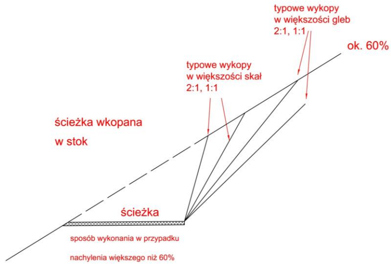
Rysunek 46. Przykład budowy szlaku o typie: wykop (2)
