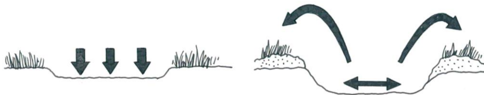
Rysunek 26. Proces stopniowego zagęszczania, zmiany profilu poprzecznego i przemieszczania cząstek budujących nawierzchnię szlaku (1)
