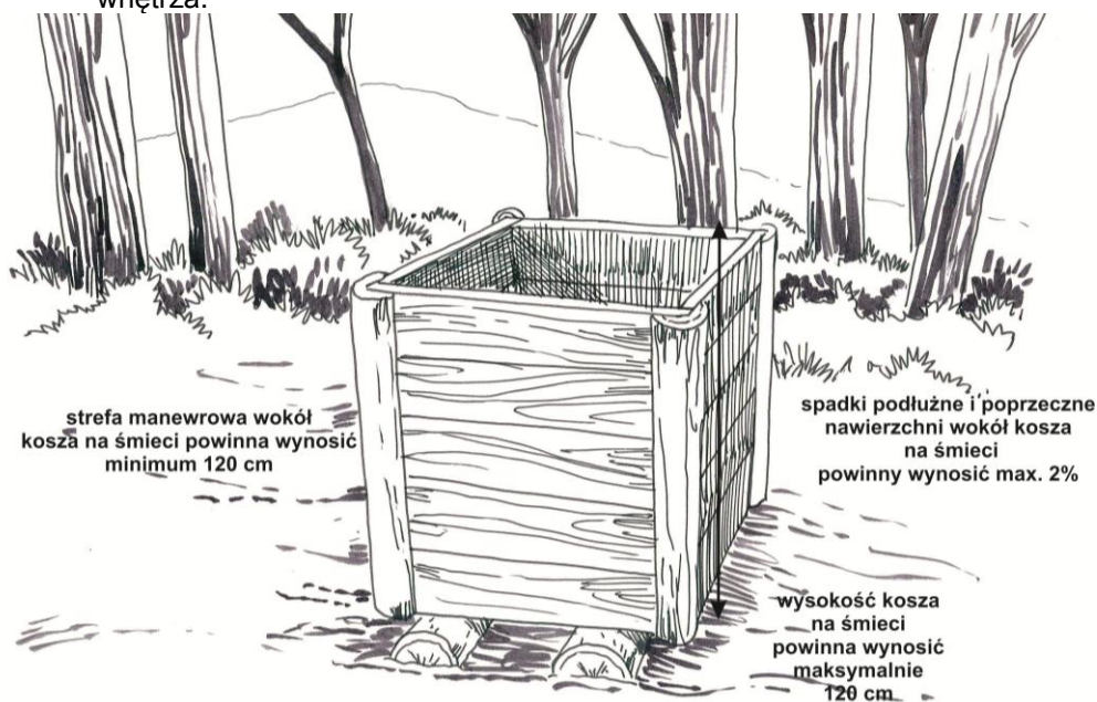
Rysunek 68. Propozycja estetyki kosza na śmieci o charakterze otwartym, spójnego z krajobrazem leśnym (1)
