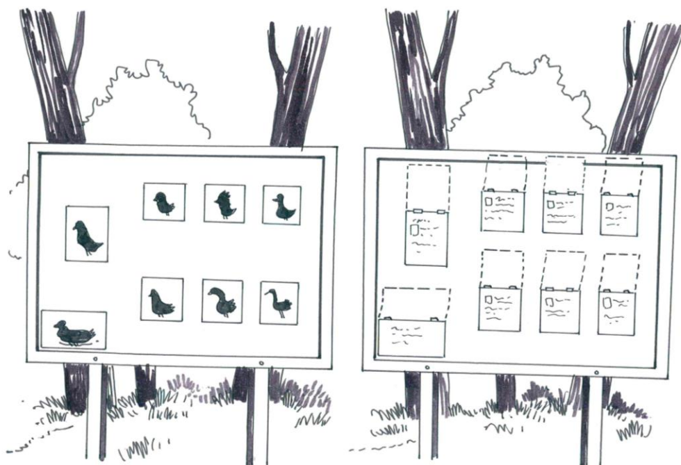
Rysunek 122. Przykłady tablic interaktywnych – podniesienie tabliczki z sylwetkami ptaków odsłania opis dotyczący danego gatunku (1)
