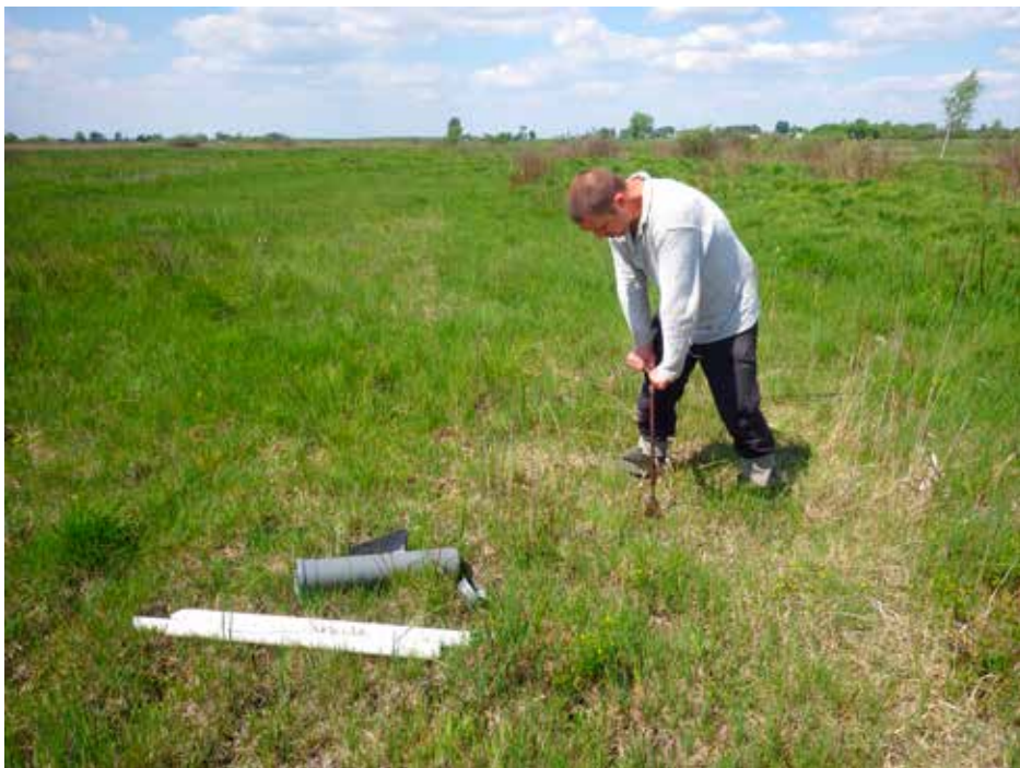
Fot. 129. Montaż piezometru z urządzeniem pomiarowym (fot. E. Gutowska).
