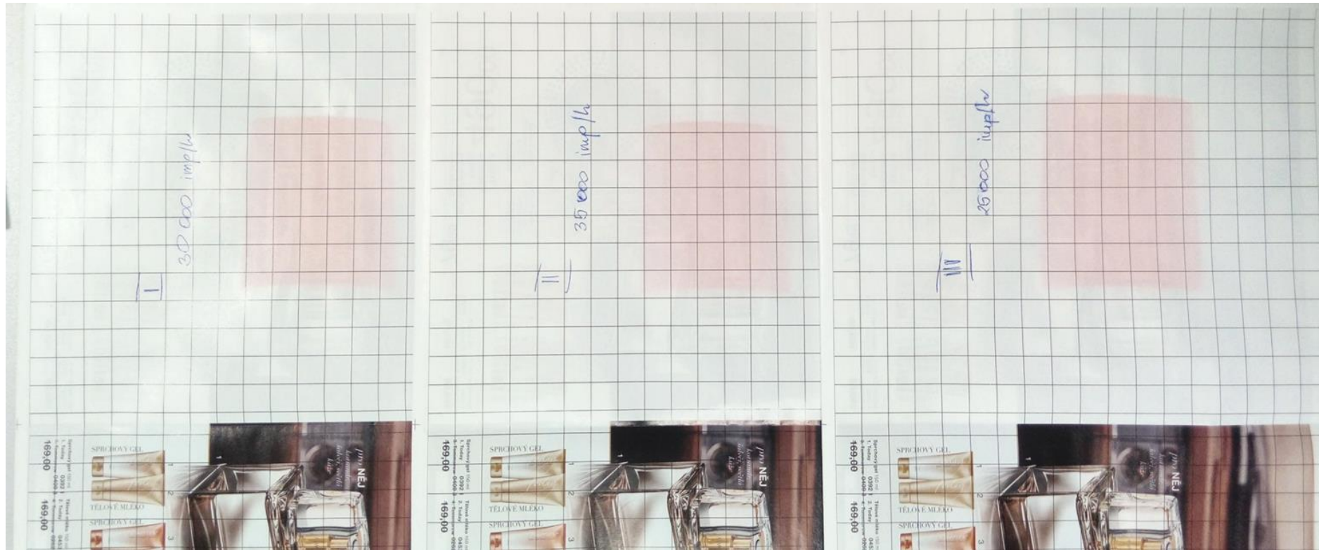
Rys. 44. Kontrola powtarzalności położenia pola na składce, natrysk lakieru dla trzech różnych prędkości podłoża: 30 000, 35 000 i 25 000 imp/h (test l.p.1)
