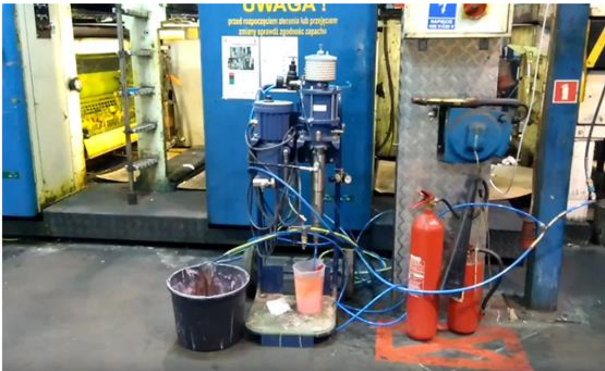
Rys.11. Stanowisko doświadczalne przystosowane do pracy w warunkach produkcyjnych – prototyp do natryskowej aplikacji lakierów zapachowych
