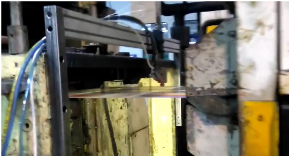
Rys.12. Stanowisko doświadczalne przystosowane do pracy w warunkach produkcyjnych – głowica natryskowa nad wstęgą papieru
