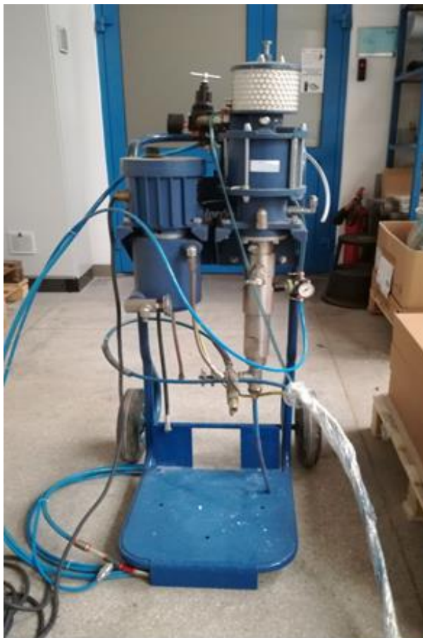
Rys.1. Prototyp do natryskowej aplikacji lakierów zapachowych
