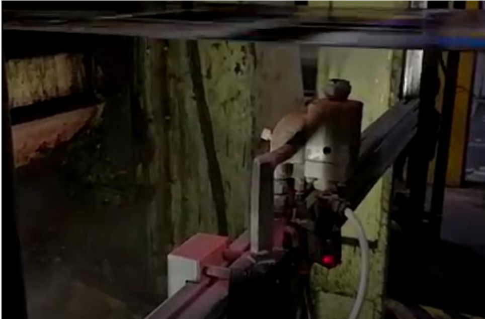
Rys. 55. Natrysk lakieru od dołu wstęgi papieru
