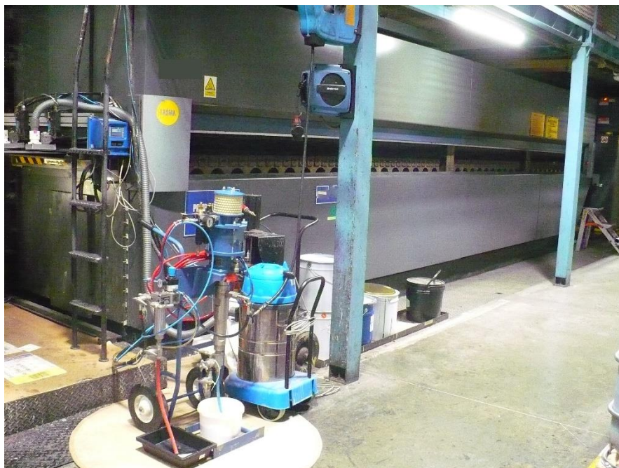
Rys.3. System odciągu mgielki lakieru z prototypem natryskowym
