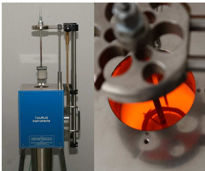
Rysunek 45. Widok stanowiska do badania niepalności oraz próbki w trakcie badania
