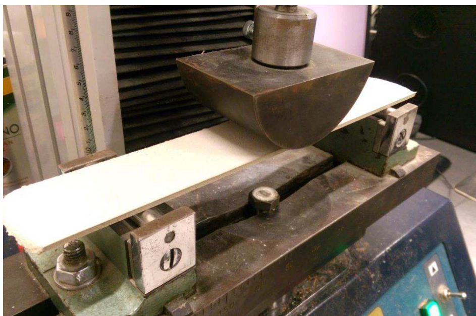
Rysunek 20. Wykonanie badanie odkształcenia poprzecznego na maszynie wytrzymałościowej
