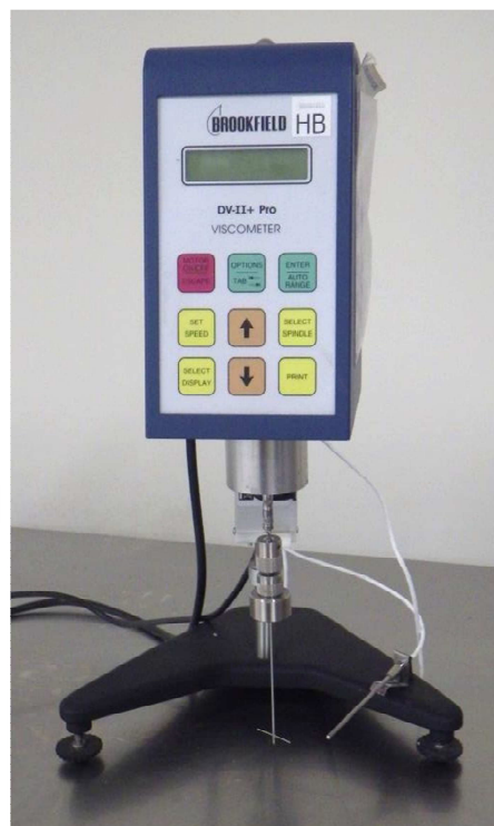
Rys. 9. Schemat budowy oraz zdjęcie wiskozymetru rotacyjnego Brookfielda z założonym wrzecionem typu T.
