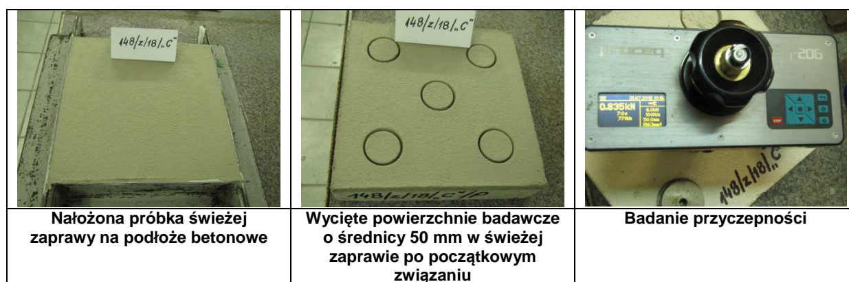
Rysunek 29. Widok stanowiska do badania przyczepności zapraw do podłoża betonowego
