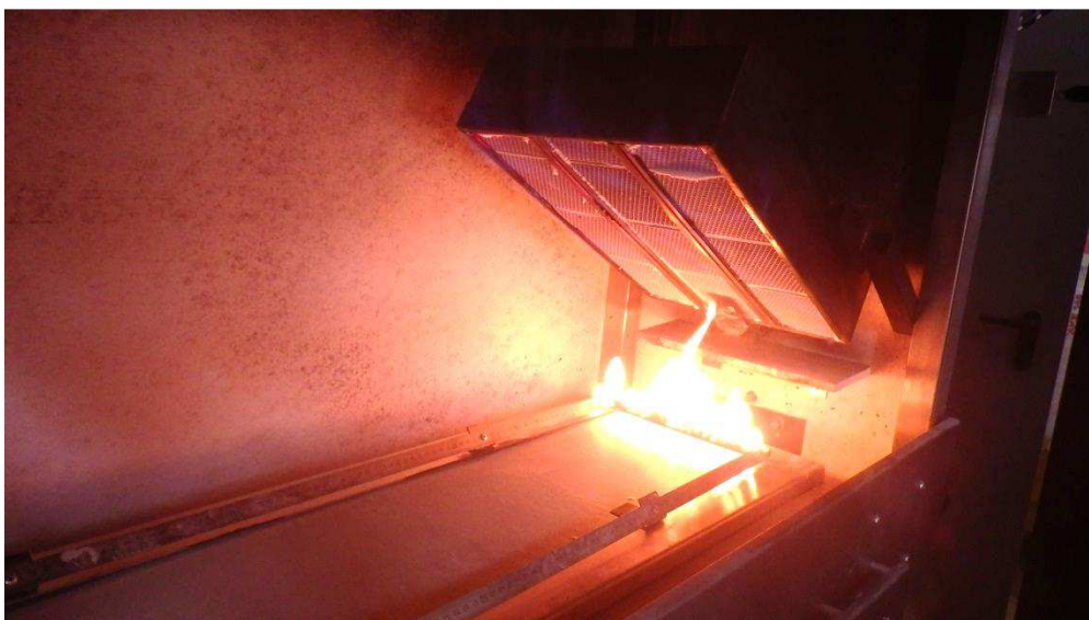
Rysunek 58. Przykładowy widok przebiegu badania próbki metodą płyty promieniującej
