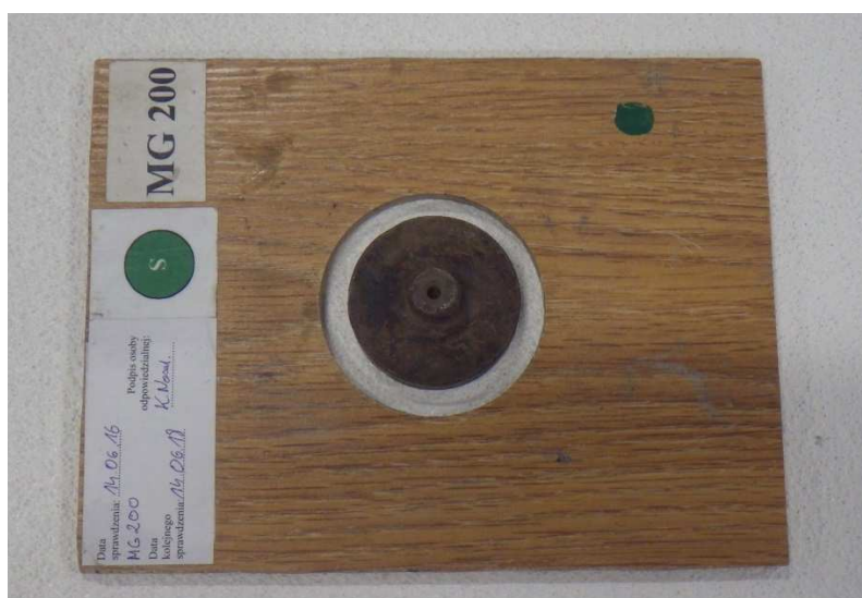
Rysunek 40. Sposób wykonania badania przyczepności do podłoża z płyty gipsowo-kartonowej
