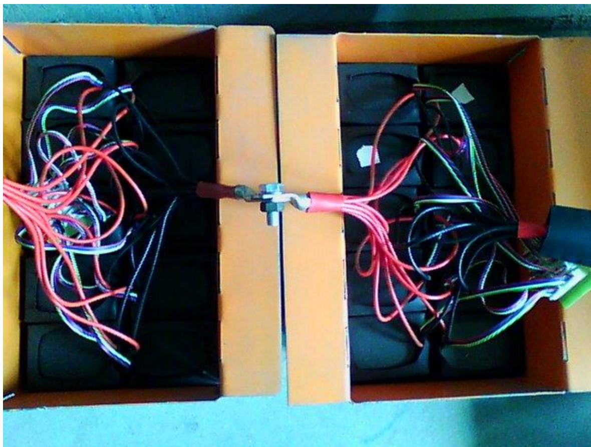
Zdjęcie 31. Połączenie ogniw grafenowo-litowo-polimerowych poprzez zaciski śrubowe
