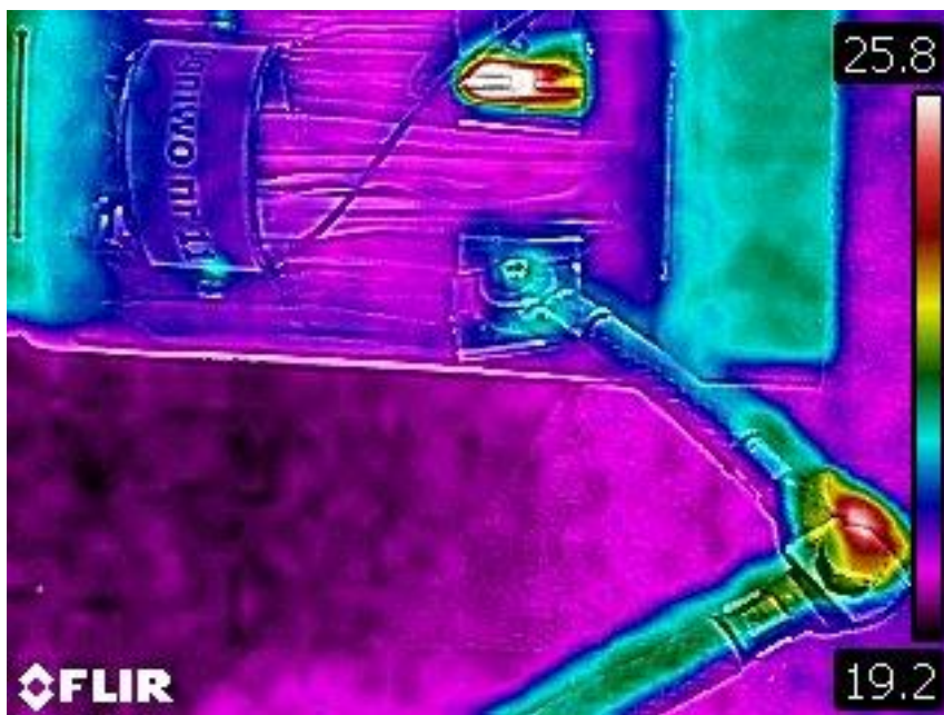
Zdjęcie 28. Połączenie śrubowe ogniw litowo-jonowych, zdjęcie wykonane kamerą termowizyjną
