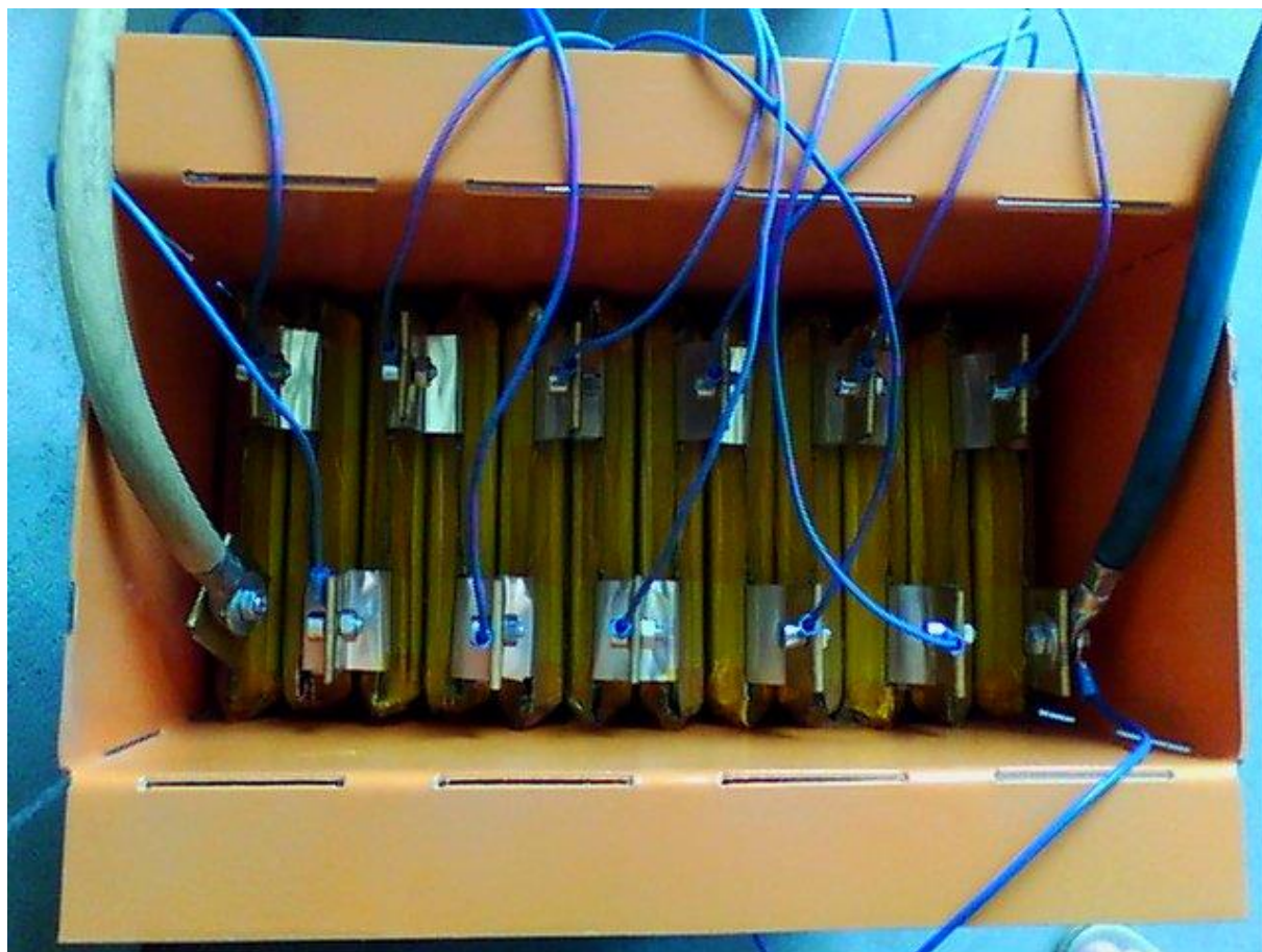
Zdjęcie 29. Połączenie cel LiFePO4 zaciskami śrubowymi
