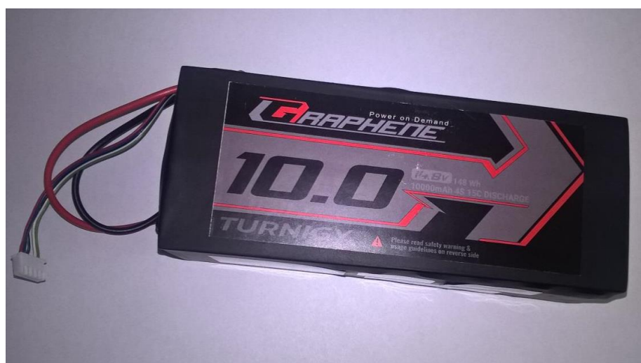
Zdjęcie 5. Ogniw grafenowo-litowo-polimerowy o pojemności znamionowej 10Ah i napięciu znamionowym 14,8V
