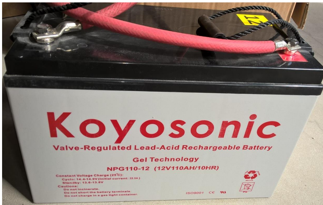
Zdjęcie 8. Akumulator ołowiowy z elektrolitem żelowym o pojemności znamionowej 110Ah i napięciu znamionowym 12V
