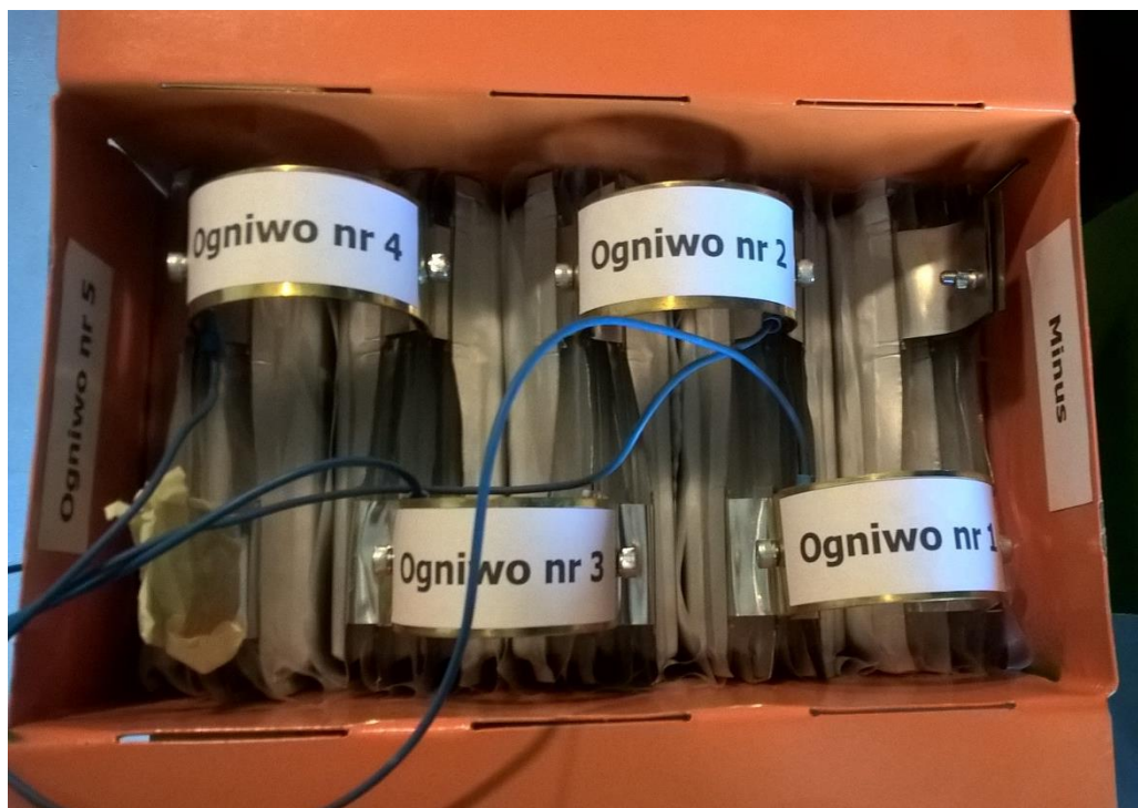
Zdjęcie 27. Połączenie ogniw litowo-jonowych poprzez zaciski śrubowe
