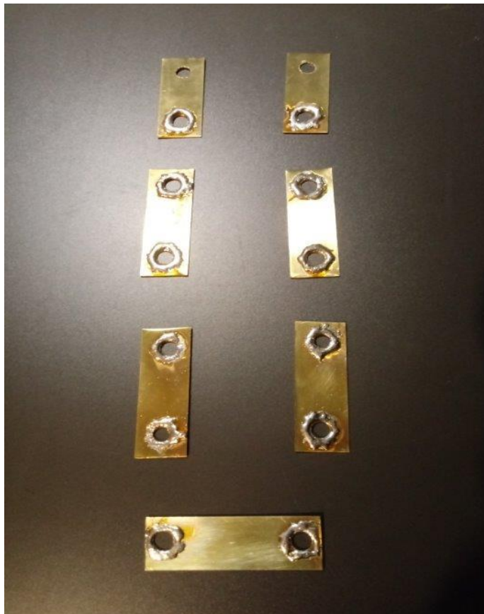
Zdjęcie 10. Zestaw mostków do łączenia akumulatorów poprzez lutowanie
