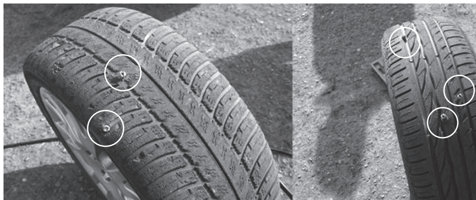
Rys. 11. Przykładowe przebicia opony podczas jednej z prób Źródło: opracowanie własne (K. Stryjek).
