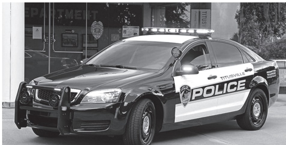
Rys. 18. Przykład elementów wzmacniających przednią część pojazdu policji USA
