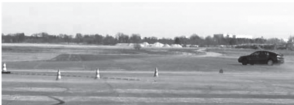
Rys. 9. Nadsterowność pojazdu podczas przejazdu badawczego Źródło: opracowanie własne (P. Stryjek).
