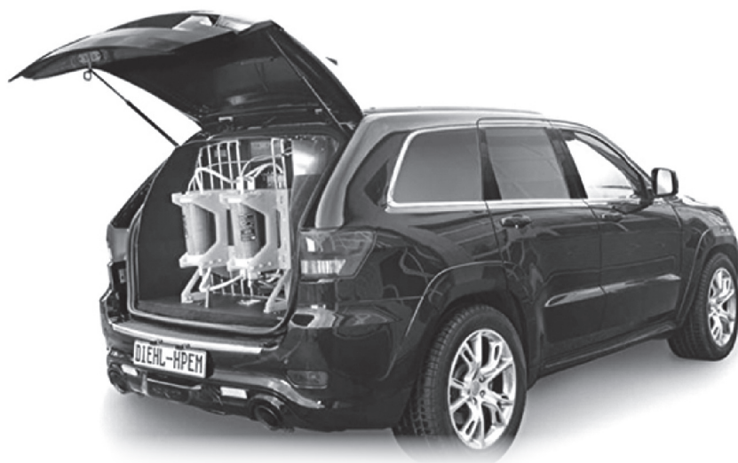
Rys. 19. Widok pojazdu demonstracyjnego firmy DIEHL wyposażonego w prototyp systemu HPEM Car Stop Źródło: DIEHL.com
