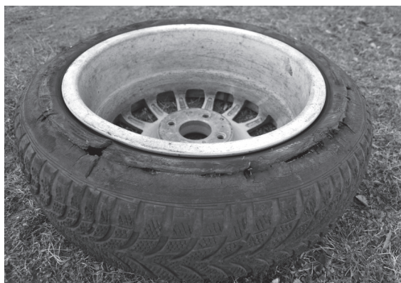
Rys. 15. Widok standardowej opony po przejechaniu dystansu ok. 2.5 km – na rysunku widać charakterystyczne przecięcie boku opony
