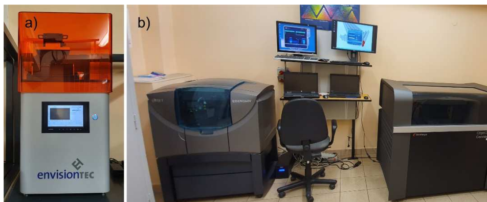
Rys. 6.3. Urządzenia wykorzystujące fotopolimeryzację: a) urządzenie DLP, b) urządzenia PolyJet
