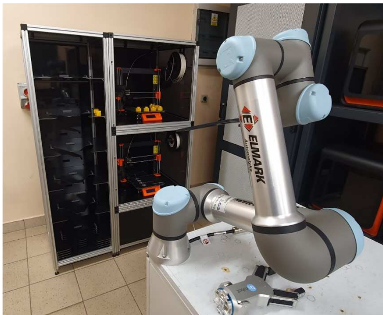
Rys. 5.5. Robot współpracujący z drukarkami 3D oraz magazynem platform
