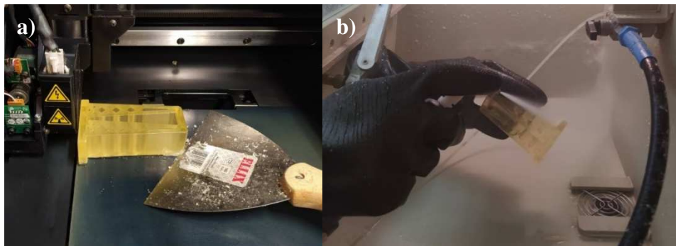
Rys. 6.16. Postprocessing modelu wykonanego metodą PolyJet: a) usunięcie z przestrzeni roboczej, b) usunięcie struktur podpierających
