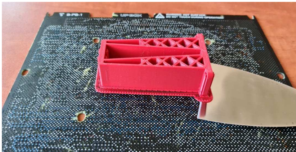
Rys. 6.17 (cd.). Postprocessing modelu wykonanego metodą MEM: b) odcięcie modelu wspornika wraz ze strukturą podpierającą od platformy roboczej w postaci płytki perforowanej
