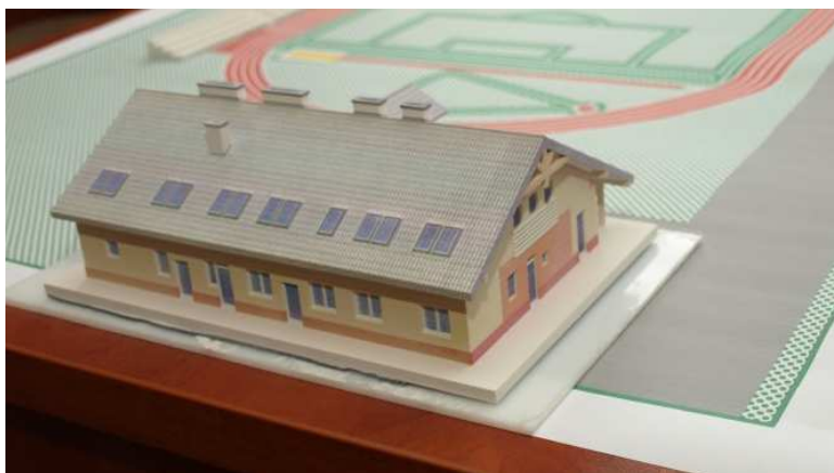
Rys. 2.16. Makieta budynku wykonana metodą 3DP
