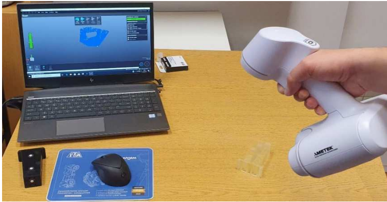
Rys. 3.7. Pomiar uchwytu lusterka samochodowego z zastosowaniem skanera CREAFORM
