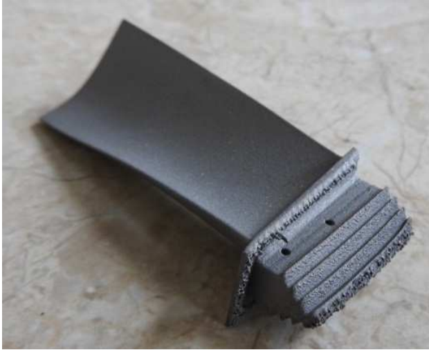
Rys. 2.8. Łopatka silnika lotniczego wykonana metodą DMLS
