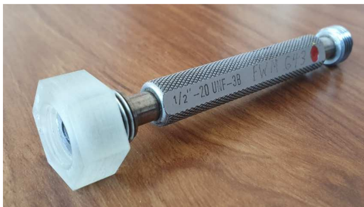
Rys. 3.5. Kontrola jakości nakrętki wykonana sprawdzianem gwintowym
