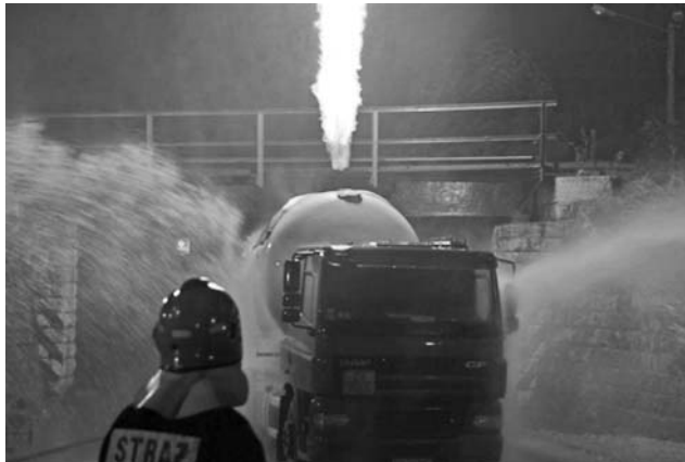
Fot. 1. Chłodzenie zbiornika cysterny (Fot. W. Rapka)
