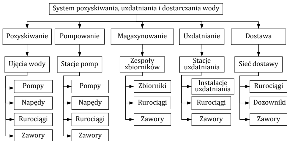
Rys. 1. Etapy pozyskiwania, uzdatniania i dostarczenia wody [1]
